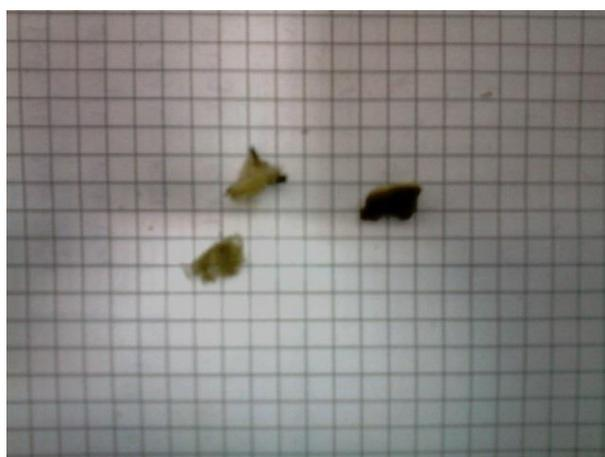
**Fig. 4.6.** Partículas de la fracción de espumas del residuo de VFU
