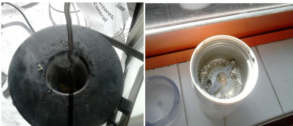
**Fig. 3.3-a)** Inmersión del material en N<sub>2</sub>; **b)** Molienda mecánica posterior
