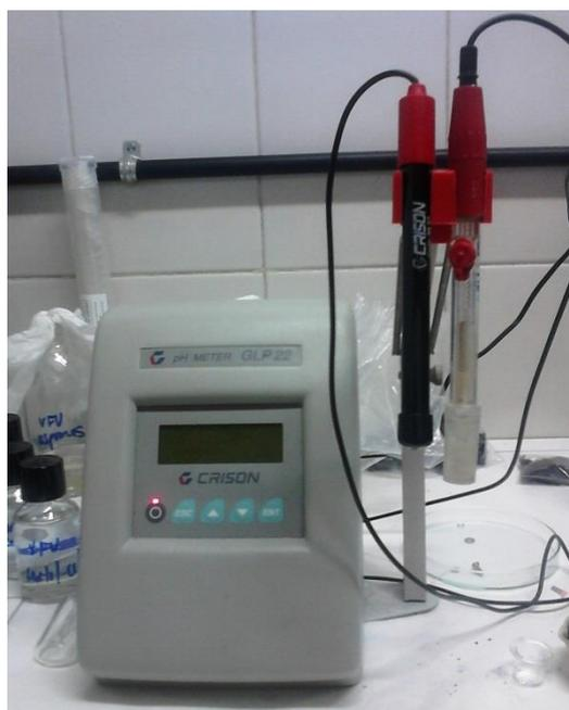
**Fig. 3.16.** pHmetro Crison GLP 22 con electrodo de referencia Ag/AgCl y electrodo selectivo de cloruros
