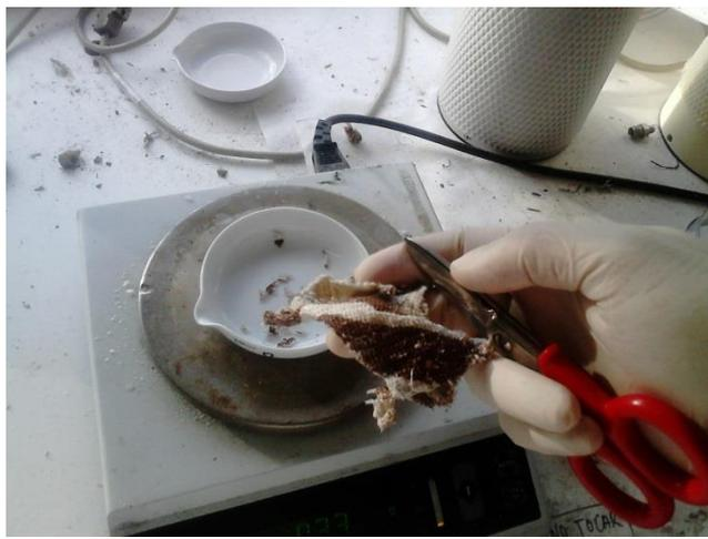
**Fig. 3.4.** Corte manual de una fracción textil
