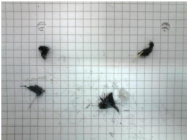
**Fig. 4.9.** Partículas bidimensionales de la fracción textil del residuo voluminoso
