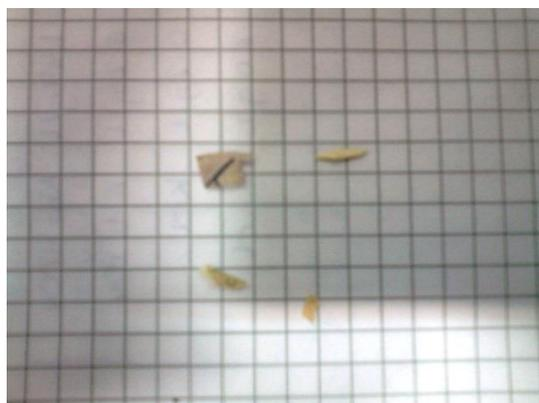
**Fig. 4.1.** Partículas de la fracción celulósica del residuo de rechazo procedente de la planta de clasificación de envases
