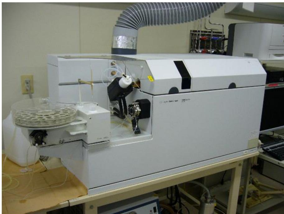
**Fig. 3.15.** Espectrómetro de Masas de cuadrupolo tipo ICP-MS con celda de colisión (modelo HP 7500c de Agilent)
