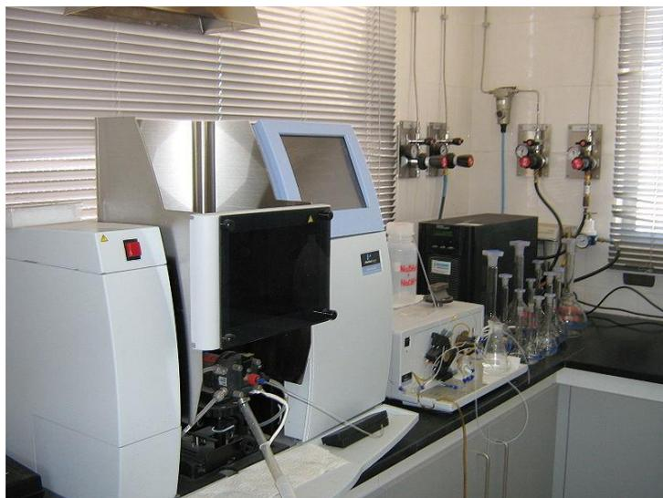
**Fig. 3.12.** Espectrofotómetro acoplado a un generador de hidruros
