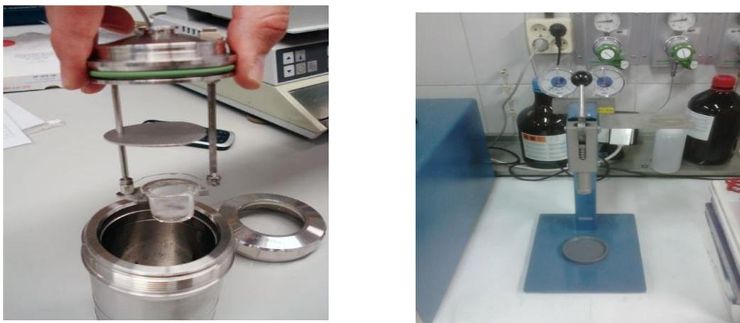
**Fig. 3.9-a)** Bomba calorimétrica instalada junto con crisol de combustión e hilo de Ni-Cr; **b)** Accesorio para la presurización de la bomba calorimétrica
