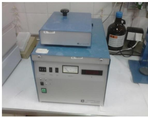
**Fig. 3.5.** Calorímetro adiabático IKA C 4000
