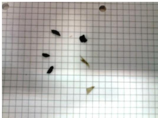
**Fig. 4.5.** Partículas de la fracción de plásticos y gomas del residuo de VFU
