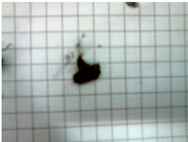
**Fig. 4.7.** Partículas bidimensionales de la fracción textil-celulósica del residuo de VFU
