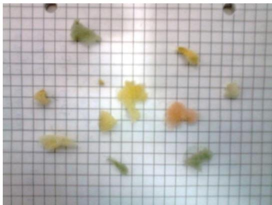
**Figura 4.11.** Partículas tridimensionales de la fracción de espumas del residuo voluminoso
