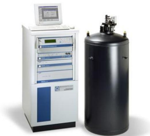
Figura 5. Magnetómetro de muestra vibrante PPMS-14 T.
