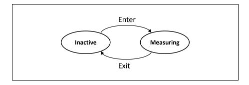
La secuencia de mensajes debe comenzar con un mensaje Enter y terminar con un mensaje Exit. Entre los mensajes Enter y Exit, cuando las cámaras reciben una señal eléctrica que dispara la captura de una nueva imagen, el MVS procesará las imágenes. Tras recibir el mensaje Exit el MVS debe ignorar cualquier imagen capturada, hasta recibir un nuevo mensaje Enter. Para un determinado carril solo habrá un mensaje Enter y un solo mensaje Exit.
