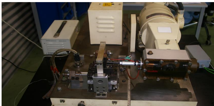
Figura 22. Equipo de fricción de alta frecuencia utilizado en los ensayos de desgaste.
