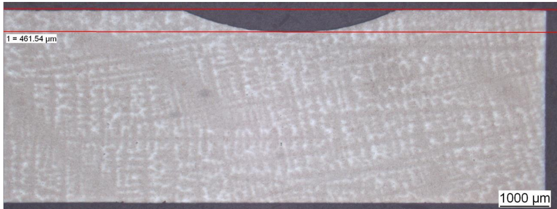
Figura 50. Profundidad de la huella en el ensayo de desgaste del acero bainítico sin tratar superficialmente
