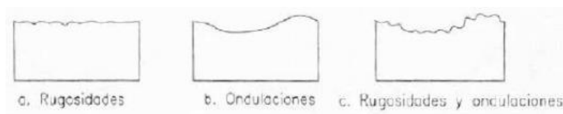
Figura 15. Diferenciación entre ondulación y rugosidad.
