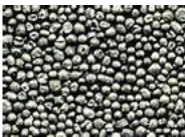
Figura 6. Proyectiles de acero de alambre cortado (cut wire).
