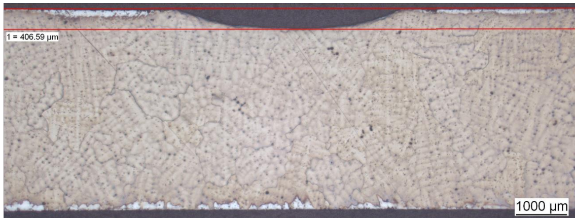
Figura 51. Profundidad de la huella en el ensayo de desgaste del acero Hadfield sin tratar superficialmente.
