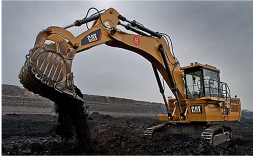
Figura 10. Excavadora Caterpillar 6015 con la configuración retro del cazo. [CAT14b]
