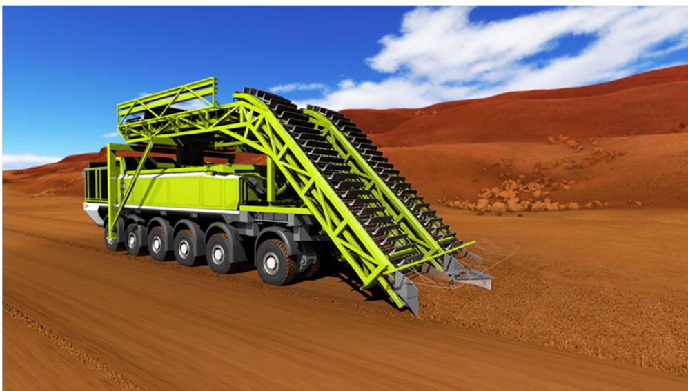
Figura 19. Modelo conceptual de sistema autocargante para volquete de la empresa EFF Mining Trucks [ETF14]
