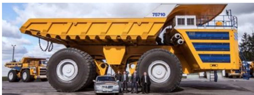
Figura 7. Camión Dúmper de la marca Belaz, modelo 75710, el de mayor capacidad de carga del mercado (450 t). [BEL14]
