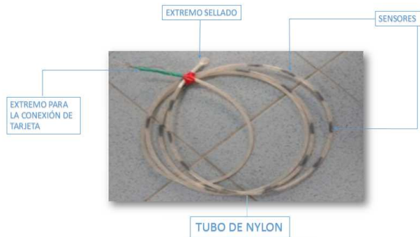
Figura 1. Montaje de sensores.
