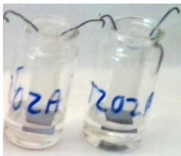
**Figura 32.** Placas de acero al manganeso recubiertas mediante una inmersión de 10 minutos en oleilamina seguida de secado con aire a presión: después de semanas de inmersión en agua mQ.
