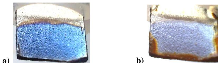
**Figura 11.** a) Placa de acero comercial (Leroy Merlin) recubierta mediante 5 ciclos de inmersión de 1 minuto en una disolución de ácido tánico (0,6 mg/ml) seguida de secado con aire a presión. b) la placa anterior después de 24 horas de inmersión en agua mQ.
