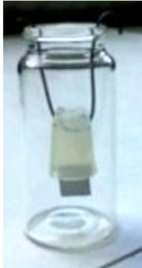
**Figura 10.** Sistema que nos permite la inmersión parcial de la placa en una disolución.
