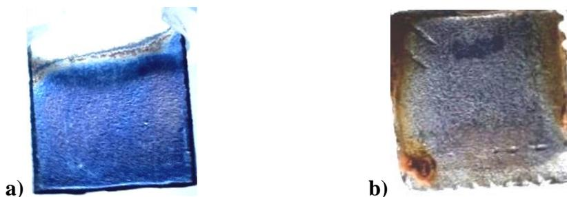
**Figura 14.** a) Placa de acero comercial (Leroy Merlin) recubierta mediante 5 ciclos de inmersión de 1 minuto en una disolución de ácido tánico (0,6 mg/ml) y  $\text{FeCl}_3 \cdot 6\text{H}_2\text{O}$  (0,05 mg/ml) seguida de secado con aire a presión. b) la placa anterior después de 24 horas de inmersión en agua mQ.
