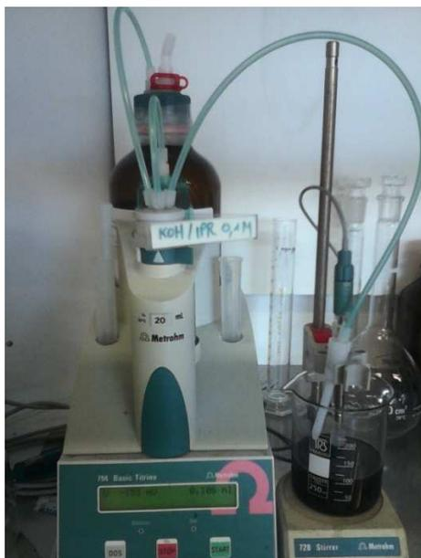
*Figure 16: Titrator Metrohm (Basic Titrino 794) and petroleum sample.*
