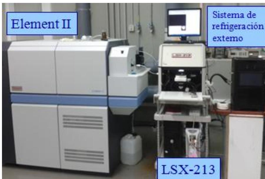
*Figura 24: Vista global de todo el equipo empleado; celda criogénica, sistema de ablación láser (LSX-213) e ICP-MS de alta resolución (Element II)*
