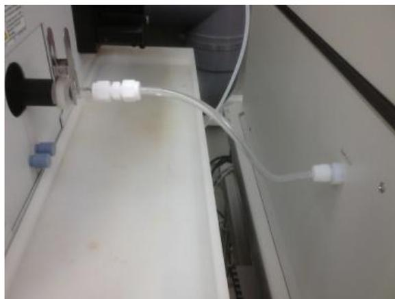
*Figura 16: Interfase de conexión láser-ICP-MS*
