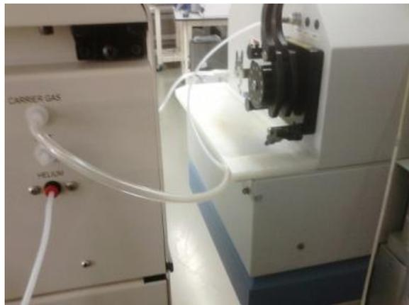
*Figura 18: Conexión salida Argón (ICP-MS)- sistema de ablación*
