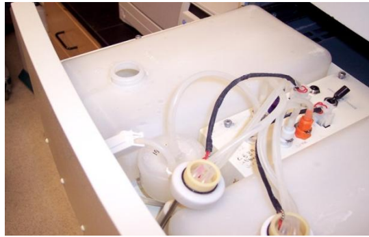
Figura 8: Tanques de desecho (derecha) y tanque de fluido FACSFlow (izquierda). A la derecha puede apreciarse la palanca para presurizar “VENT VALVE”.
