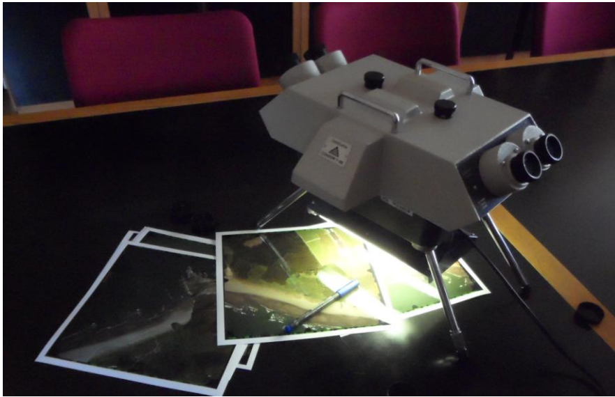
Figura 3. Estereoscopio Ushikata, Condor Gemelo T-22 para visión simultánea.
