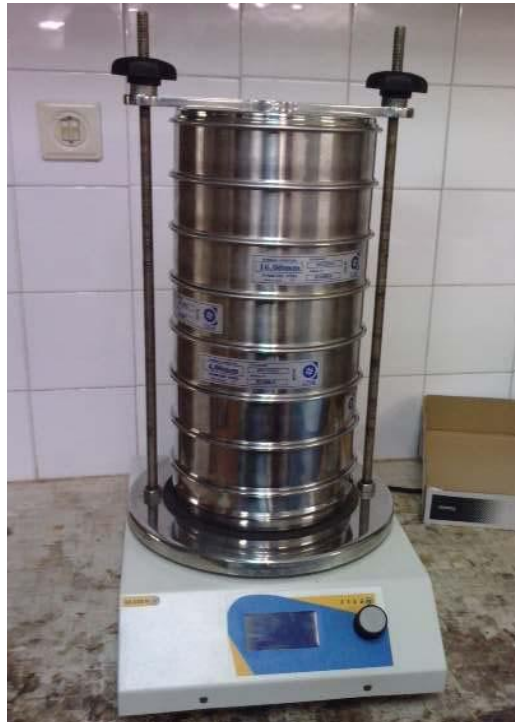
Figura 6. Tamizadora de vibración y columna de tamices utilizada en los análisis granulométricos.
