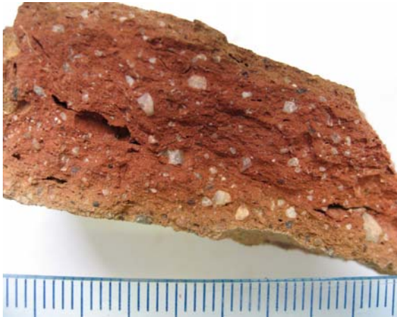
Fig.1. Aspecto general de la muestra observada a simple vista. Se aprecian las bandas externas más claras.
