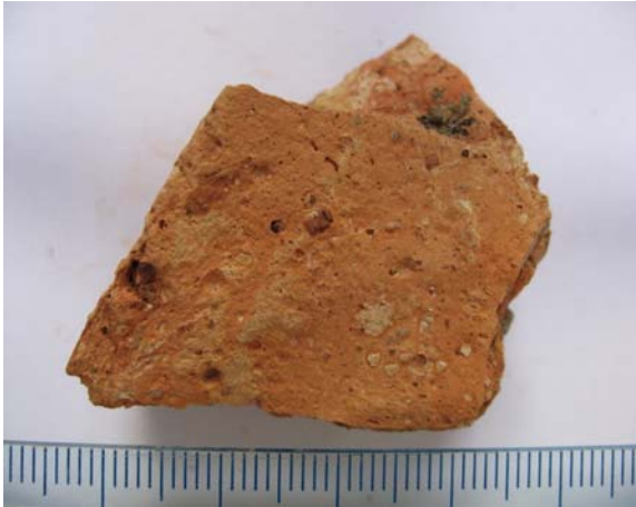
Fig.1. Aspecto de la muestra a simple vista. Destacan algunos granos de cuarzo, poros y zonas blanquecinas.
