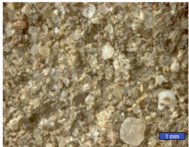
Fig. 2. Granos insolubles a la lupa binocular (x10 aumentos). Se observan granos de cuarzo translúcidos de diferentes tamaños de grano.
