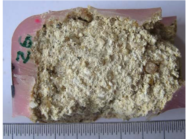
Fig. 2. Superficie de corte de sierra. Destaca la presencia de áridos de cuarzo y agregados blancos de cal.
