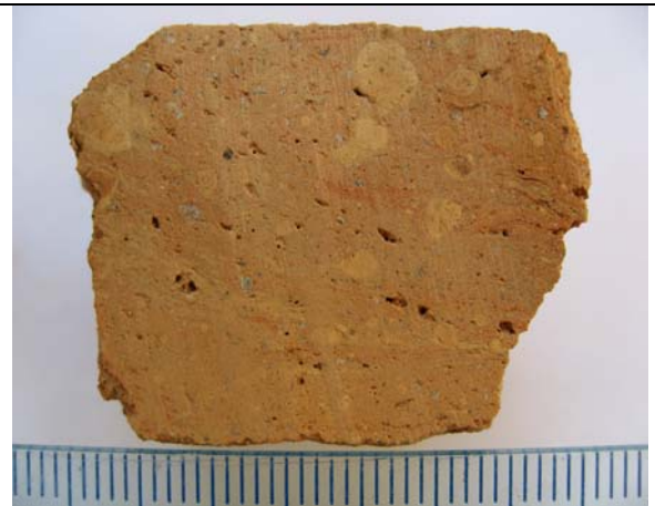
Fig.2. Superficie de corte de sierra. Resalta el aspecto masivo y homogéneo de la muestra, en la que se observan pellas con un tono más claro que la pasta y algunos poros.
