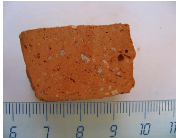
Fig.2. Superficie de corte de sierra. Se observan granos blanquecinos (cuarzo), rojos (pellas), y poros alargados distribuidos por la pasta rojiza.
