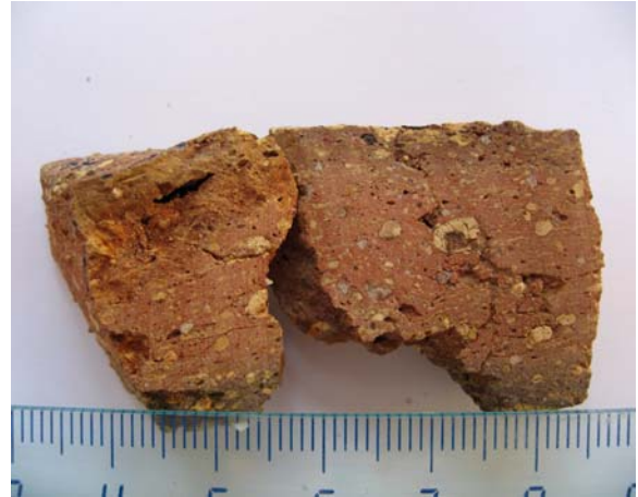
Fig.2. Superficie de corte de sierra, donde se observan las bandas exteriores más marrones, granos amarillentos y pequeños poros.
