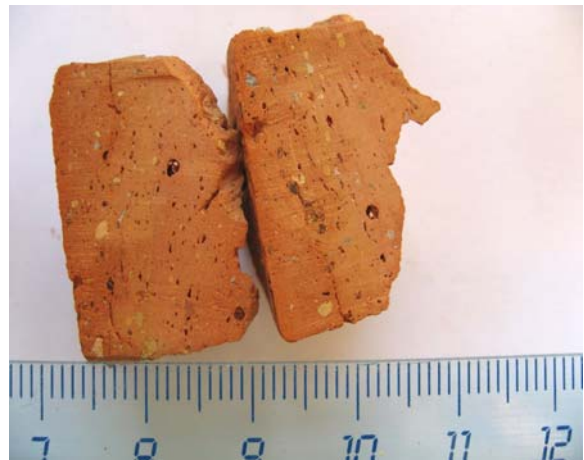
Fig.2. Superficie de corte de sierra. Se observa un aspecto ligeramente granular formado por granos de cuarzo y pellas.
