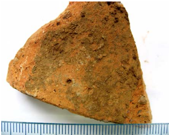
Fig.1. Aspecto de una cara externa de la muestra a simple vista. Se observa una pátina oscura y bandas amarillas
