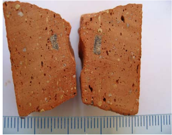
Fig.2. Superficie de corte de sierra. Destaca un gran fragmento de roca, granos de cuarzo, pellas amarillentas y poros a veces alargados y orientados.
