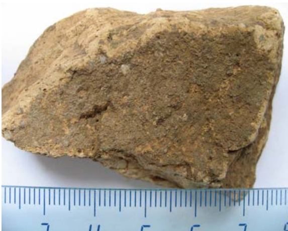
Fig.1. Aspecto de una cara externa de la muestra a simple vista, donde se observa una pátina de alteración más oscura que su parte interior.
