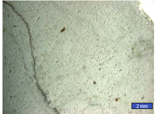
Fig. 2. Superficie de corte a la lupa binocular (x10 aumentos). En la parte izquierda se observa una fisura.
