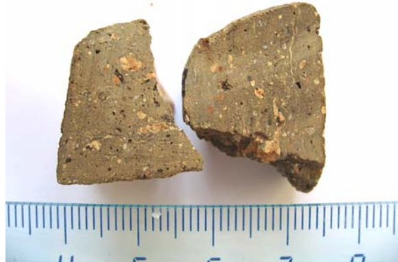
Fig.2. Superficie de corte de sierra. Se observan granos y laminillas amarillentas, algunos granos grises y pequeños poros.
