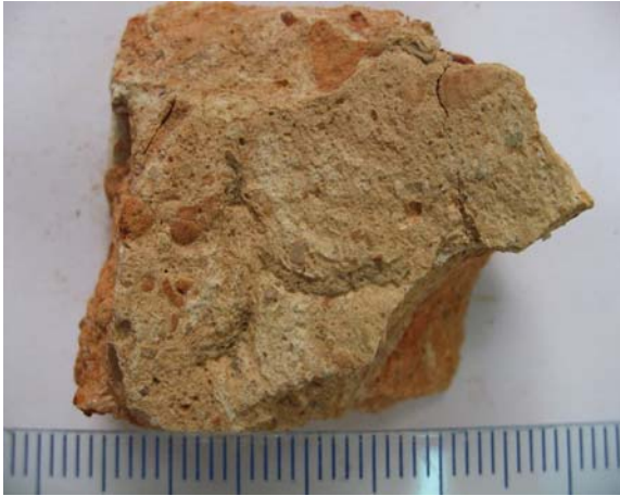
Fig.1. Aspecto de la muestra a simple vista. Se observan granos de cuarzo y pellas rojizas, y el aspecto más claro de la cara externa de la muestra.
