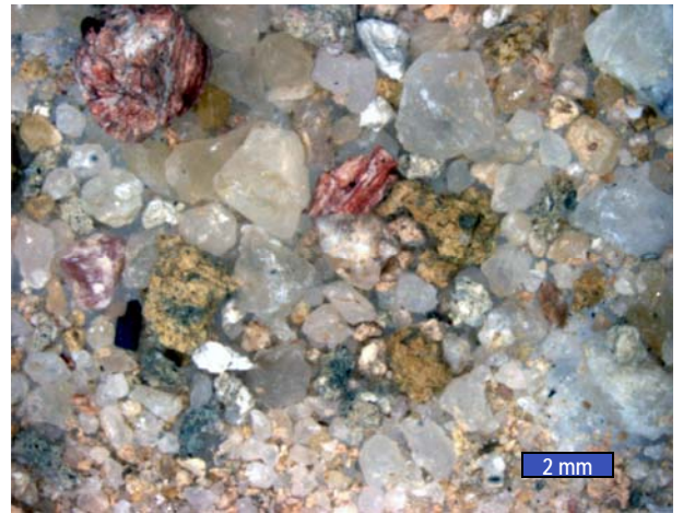
Fig. 2. Granos insolubles a la lupa (x10 aumentos). Se observan granos de cuarzo translucidos, junto a otros más pequeños y ocreos de feldespato, y en la parte superior algunos fragmentos rojizos de ladrillo.
