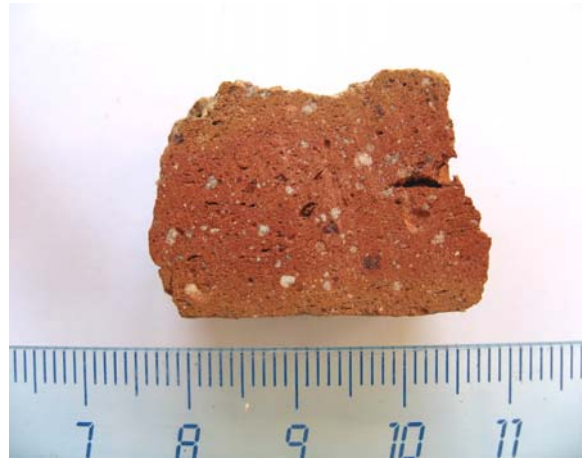
Fig.2. Superficie de corte de sierra. Destacan granos blancos (cuarzo) y rojos oscuros (opacos) dispersos entre la pasta.
