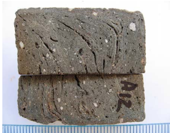
Fig.2. Superficie de corte de sierra. Destaca el color gris oscuro de la pasta y la abundancia de microgrietas orientadas y curvadas.
