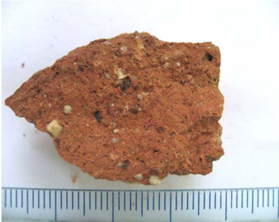
Fig.1. Aspecto general de la muestra observada a simple vista. Destacan distintos tipos de granos milimétricos.
