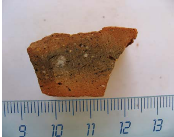
Fig.2. Superficie de corte de sierra. Se observa el aspecto ligeramente granular y una banda gris en la parte interior de la muestra.
