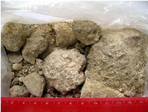
Fig. 1. Muestra observada a simple vista, destaca el aspecto granular y el color ocre.
