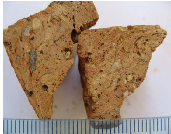
Fig.2. Superficie de corte de sierra. Destacan granos de cuarzo grises, pellas amarillentas y poros alargados orientados.
