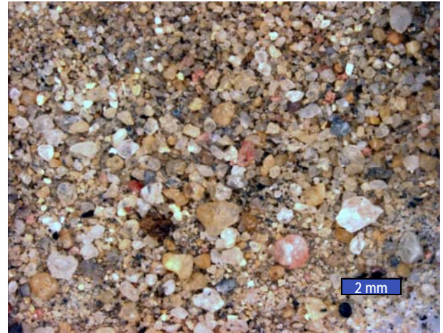
Fig. 2. Granos insolubles a la lupa (x10 aumentos). Predominan los granos de cuarzo transparentes a ocre, de tamaño arena fina a limo (0,2 a 0,02 mm), junto a algún otro de color rojo (ladrillo) y negro (resto vegetal).
