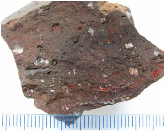
Fig.1. Aspecto de la muestra a simple vista. Se observan granos grises de cuarzo y zonas de color rojo intenso ricas en hierro.
