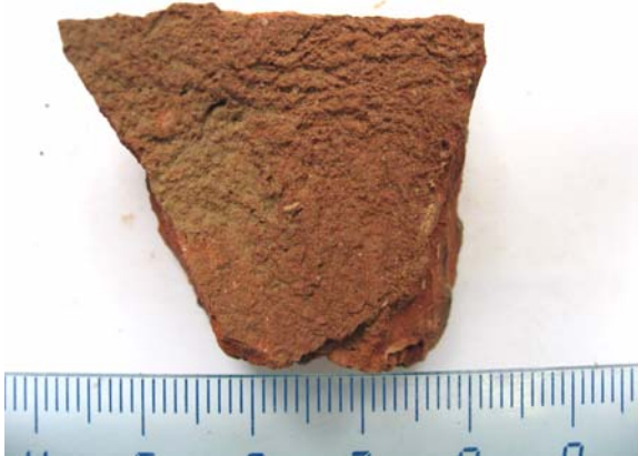
Fig.1. Muestra observada a simple vista. Destaca el aspecto homogéneo que presenta su parte externa y la ausencia de granos de tamaño arena gruesa.
