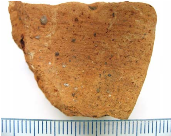
Fig.1. Aspecto de la muestra a simple vista. Se observan granos de cuarzo y la pasta rojiza bastante homogénea.
