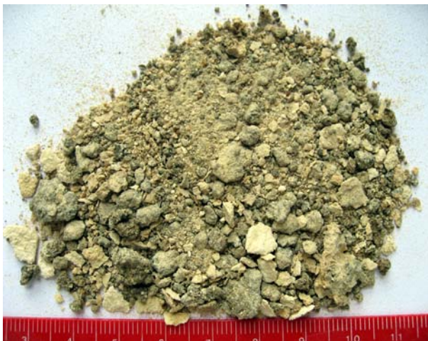
Fig. 1. Aspecto de la muestra a simple vista. Destaca la presencia de agregados blancos (nódulos de cal).
