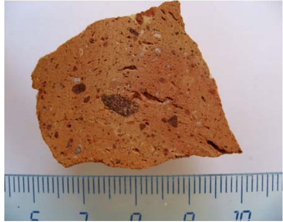
Fig.2. Superficie de corte de sierra. Se observan granos blancos a grises, otros rojos oscuros a veces de gran tamaño, algunos poros y la pasta rojiza.
