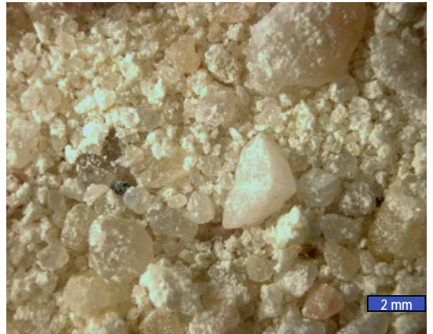
Fig. 4. Granos insolubles a la lupa binocular (x10 aumentos). Predominan los cuarzos translúcidos, junto a feldespatos y agregados de arcilla (blancos).
