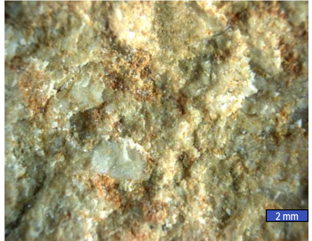
Fig. 2. Muestra a la lupa binocular (x10 aumentos). La tonalidad rojiza es debida a óxidos de Fe.
