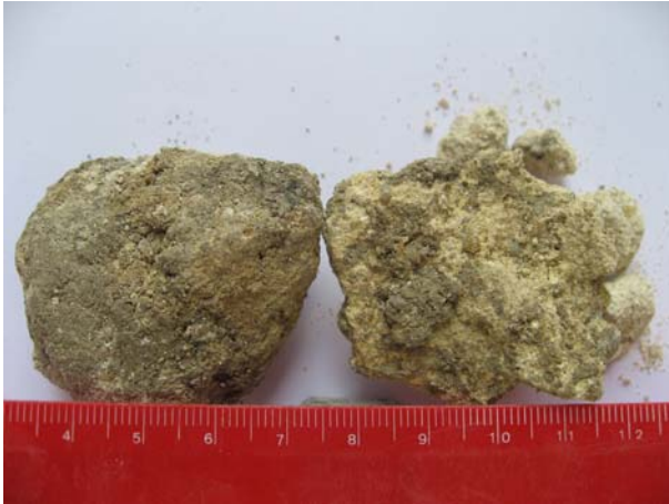
Fig. 1. Muestra observada a simple vista. La superficie está contaminada por arcillas de color amarillento.
