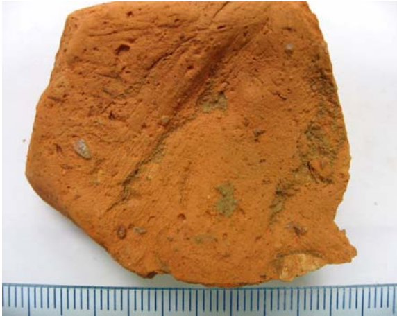
Fig.1. Aspecto de la muestra observada a simple vista. Destaca el color rojizo y uniforme de la pasta.
