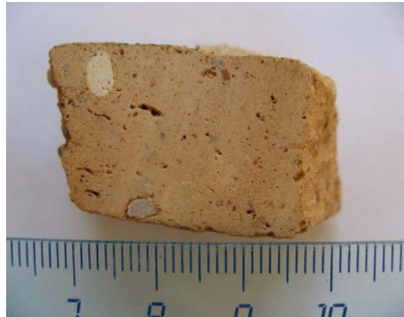
Fig.2. Superficie de corte de sierra. Destacan dos grandes granos redondeados uno amarillento (pella) y otro gris (cuarzo), además se observan poros milimétricos.
