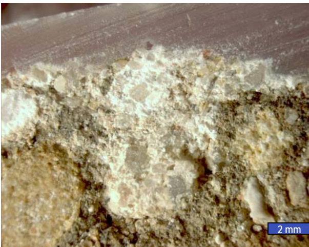
Fig. 3. Detalle de la superficie a la lupa binocular (x10 aumentos). En el centro se aprecia un fragmento de mortero con granos de cuarzo y aglomerante (blanco).
