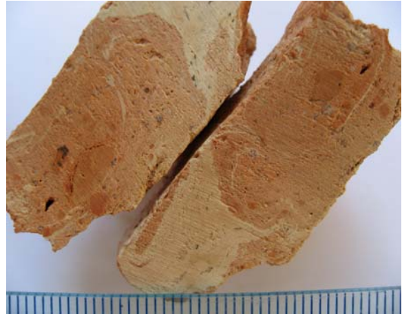
Fig.2. Superficie de corte de sierra. Destaca el aspecto heterogéneo, con zonas más blanquecinas y lentejones más rojizos dentro de la pasta roja mayoritaria.
