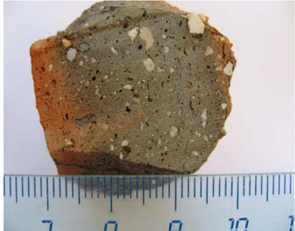
Fig.2. Superficie de corte de sierra. Se observa el aspecto bandeado de la muestra, en la que destacan granos blancos y abundantes poros alargados y redondeados.
