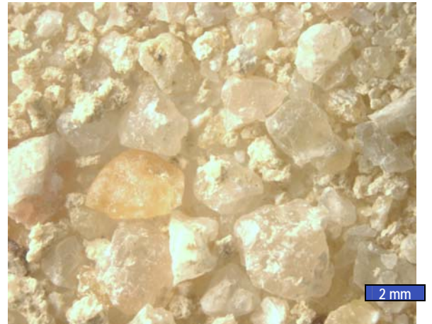
Fig. 4. Granos insolubles a la lupa binocular (x10). Predominan los granos de cuarzo translúcidos, junto a algunos agregados blancos y ocre.
