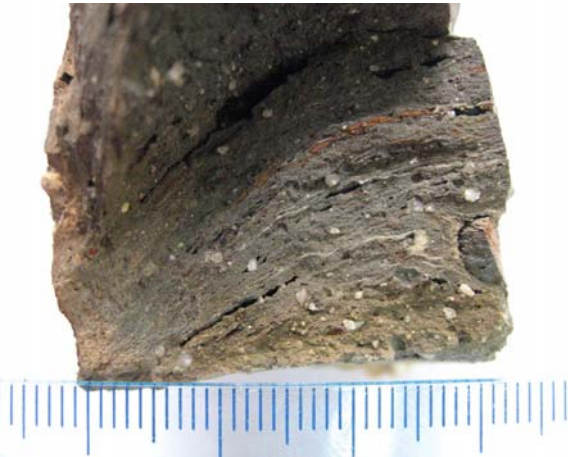
Fig.1. Aspecto de la muestra a simple vista. Se observan granos de cuarzo grises, finas bandas rojizas y amarillentas, y microgrietas mostrando la orientación.
