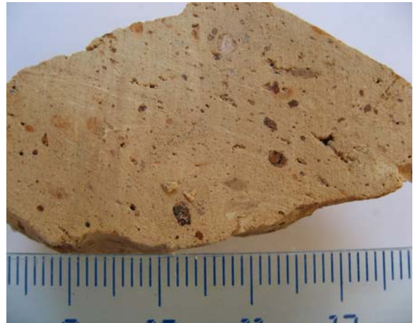
Fig.2. Superficie de corte de sierra. Cabe destacar el aspecto uniforme de la pasta, y la presencia de granos blanquecinos (cuarzo), rojizos (pellas) y rojos oscuros (opacos)
