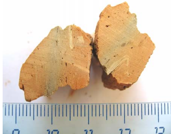
Fig.2. Superficie de corte de sierra. Destaca la ausencia de granos de tamaño arena gruesa, presencia de poros pequeños y de algunas zonas más claras.
