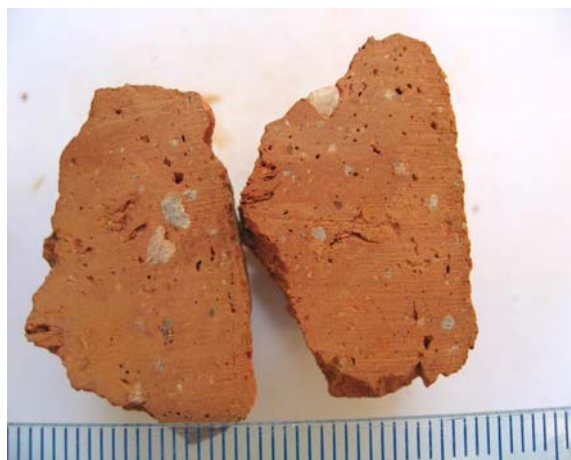
Fig.2. Superficie de corte de sierra. En la pasta se observan distintos tipos de granos claros milimétricos.
