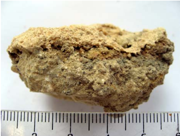
Fig. 1. Aspecto a simple vista del fragmento de mortero. Se observan distintos tipos de granos y variación del color entre la parte inferior y la capa superior, en relación con procesos de cementación y formación de costras.
