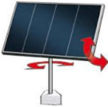
Imagen 5: Seguidor solar de dos ejes
