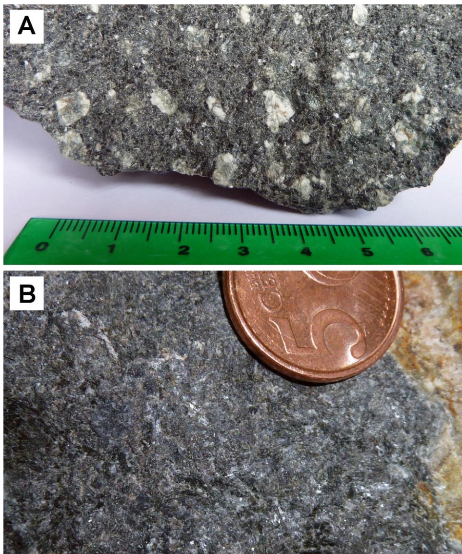
Figura 4.4. Detalle de la textura macroscópica de la roca metabásica en Ceclavín. A: facies porfídica con fenocristales de plagioclasa. B: facies gabroica de grano medio. En el borde derecho aparece una vena de epidota.
