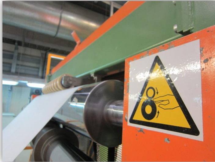
Figura 21: Zona de peligro de atrapamiento
