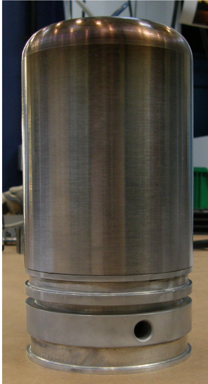
Figura A. 7: Pistón caliente y domo.
