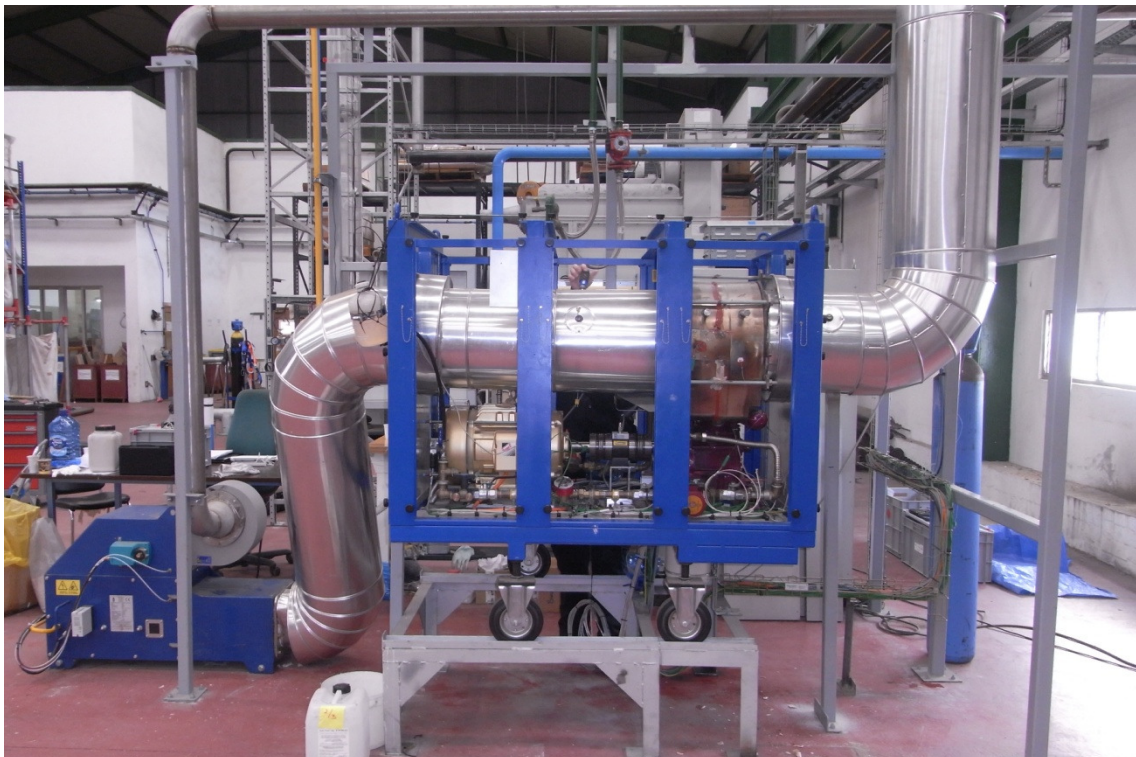
Figura 38: Banco de Ensayos de Motores Stirling, en las instalaciones del CEDER, Soria. (Imagen cedida por la Fundación Tekniker).
