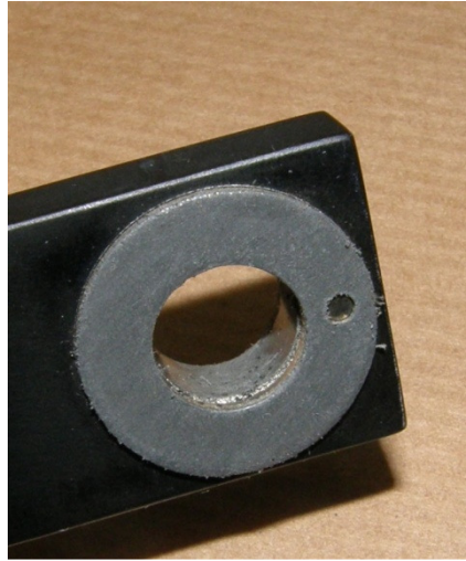
Figura A. 3: Casquillo biela lateral-bancada.
