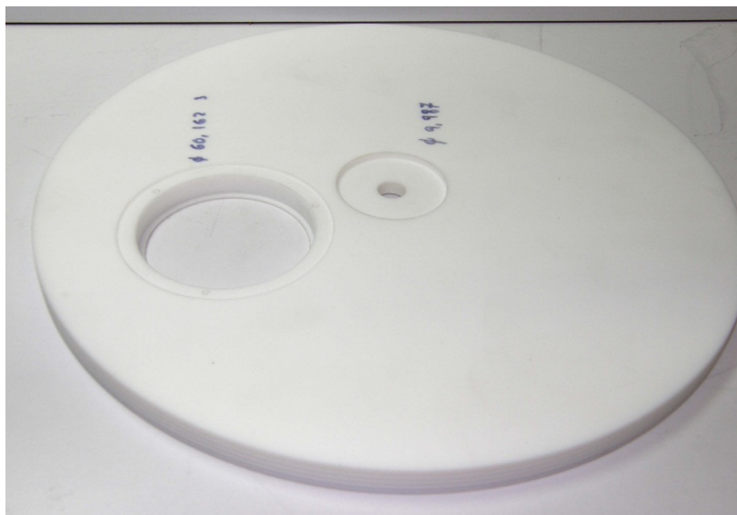
Figura 150: Desplazador de PTFE.
