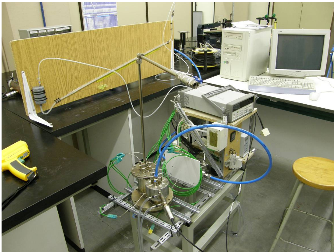
Figura 74: Banco de ensayos para el nuevo calentador.
