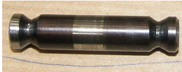
Figura A. 4: Bulón biela lateral- yugo.
