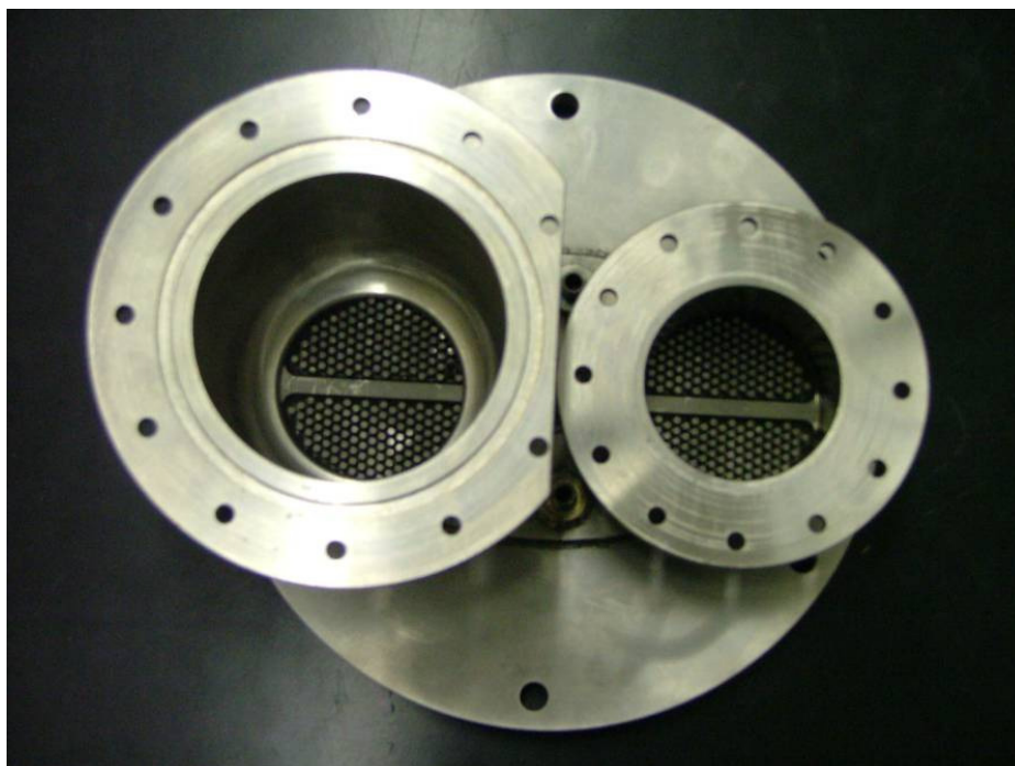
Figura 60: Vista del conjunto calentador y cilindros del regenerador y del domo.
