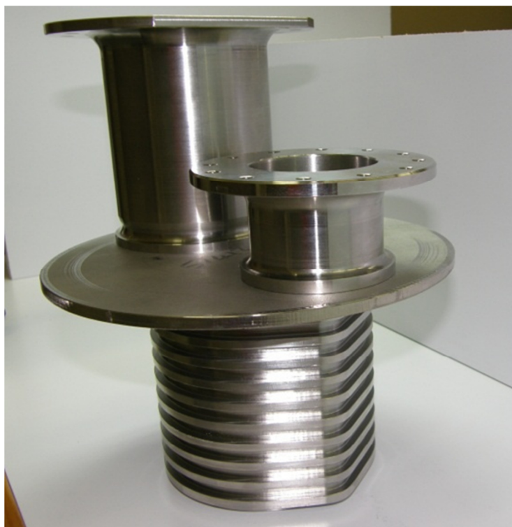
Figura 113: Vista de conjunto del calentador alternativo, junto con los cilindros del domo y regenerador.
