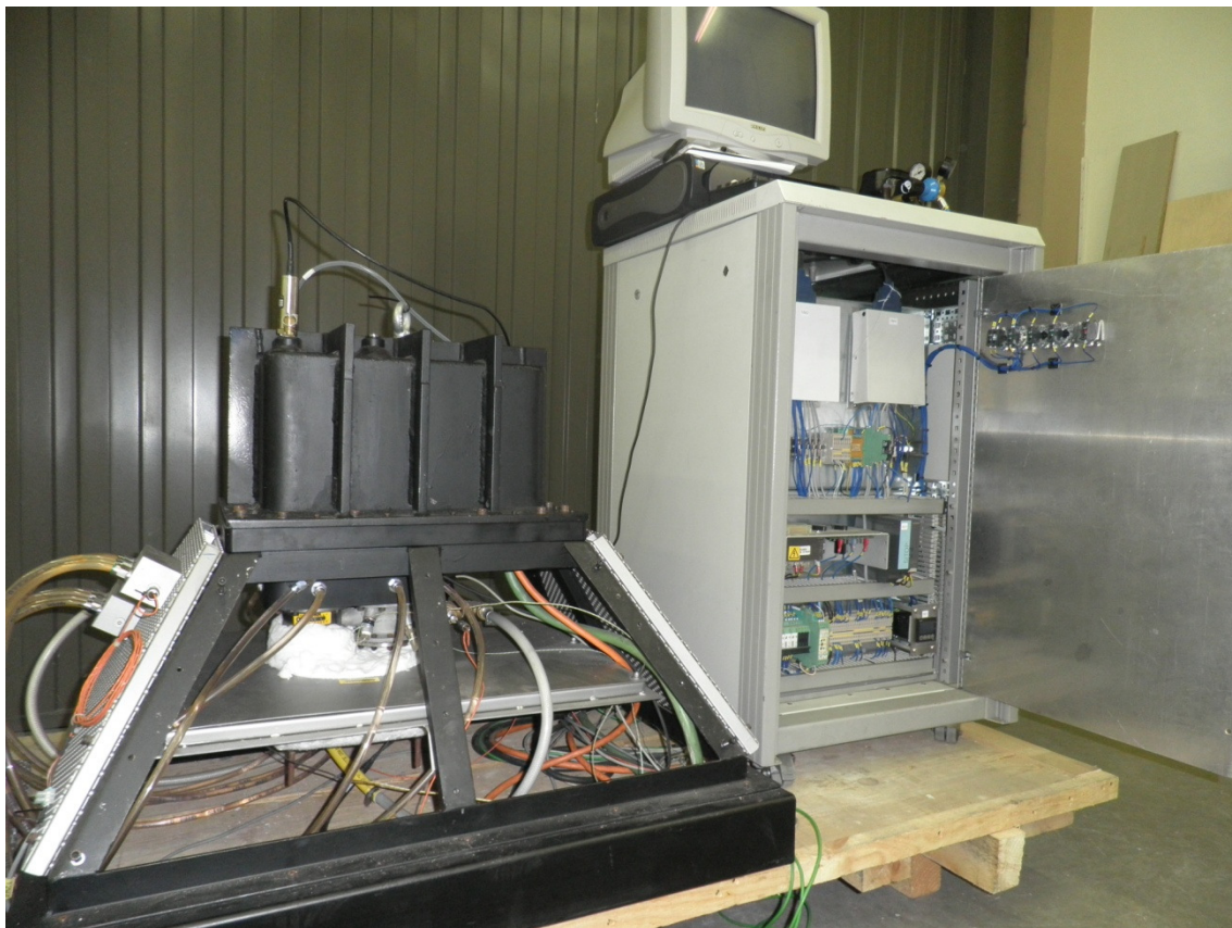
Figura 93: Vista de conjunto del motor y el sistema de adquisición de datos y control.
