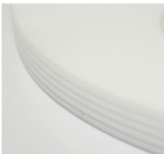
Figura 151: Detalle de junta de laberinto en el lateral del desplazador.
