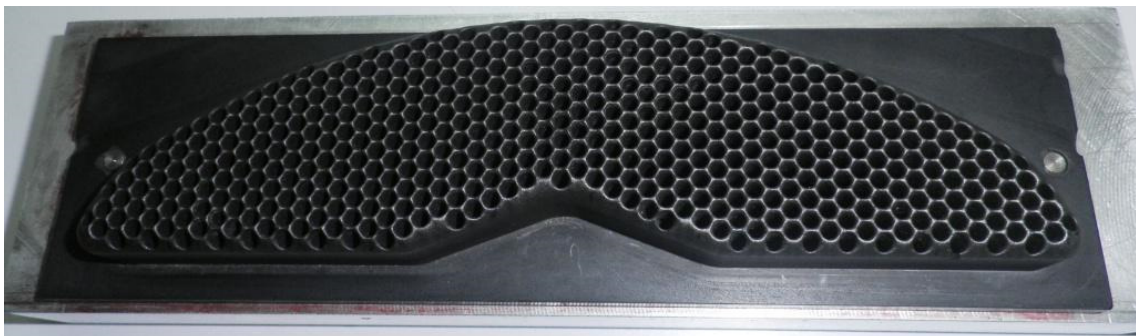
Figura 59: Electrodo de grafito utilizado en la fabricación del calentador no tubular.
