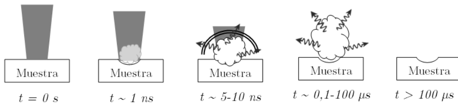
Figura 1. 16: esquema explicativo de la interacción de un pulso láser de ~10 ns con un material sólido y tiempos aproximados de los procesos experimentados.
