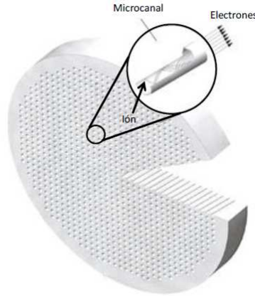
Figura 1. 30: esquema de un detector MCP
