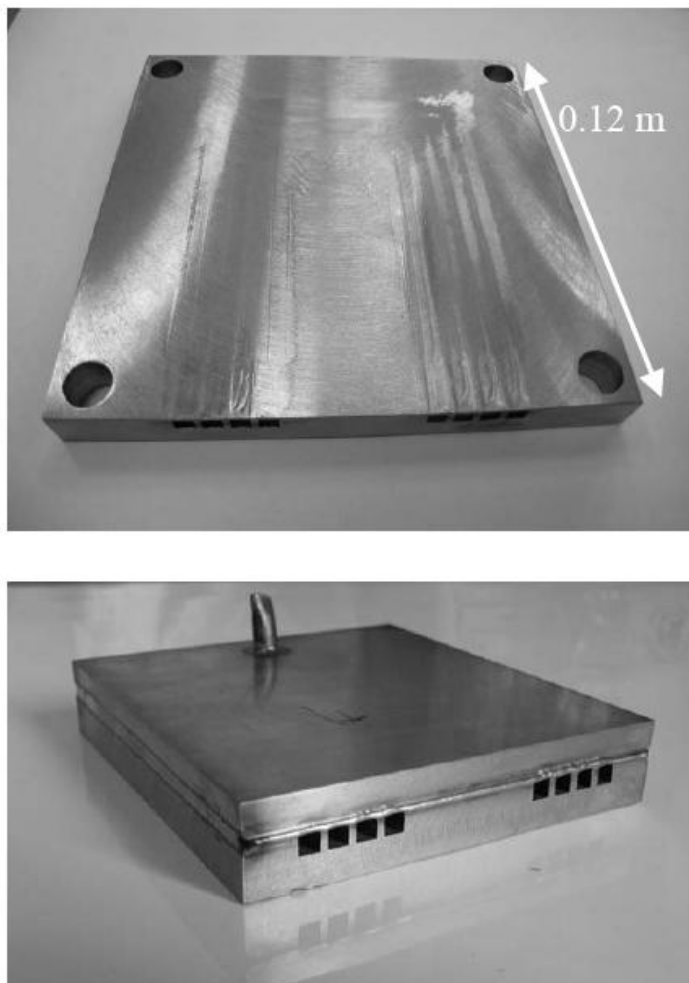
Figura 6. 3 Maqueta de una placa refrigerante con canales internos en forma de U producidos mediante láser y un proceso HIP-DW. La imagen superior se corresponde con la placa tras láser y tratamiento superficial. La imagen inferior sería la placa preparada para el proceso final de HIP
