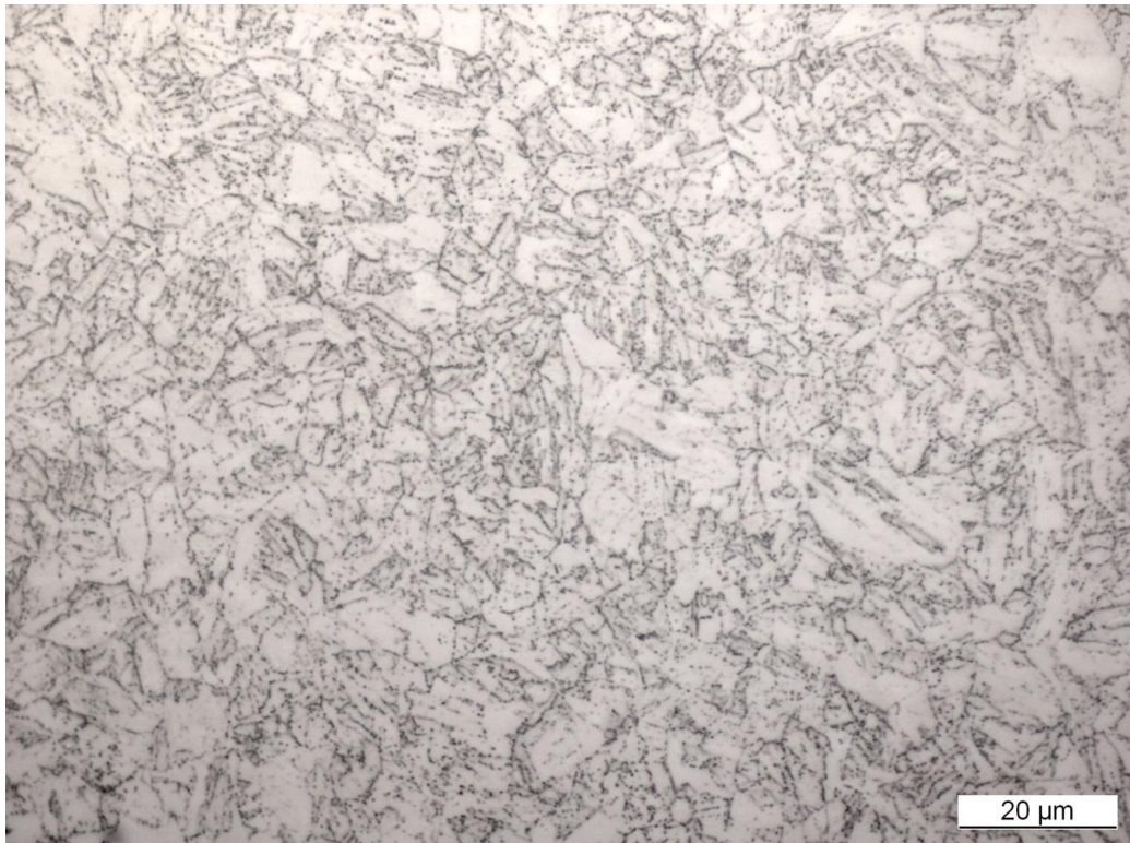
Figura 5. 29. Microestructura de la calidad AF2 en estado final de temple+revenido.
