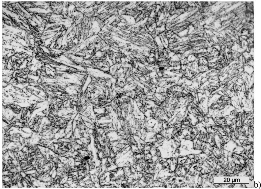
Figura 5. 20. Micrografía del Asturfer ® calidad 1 (AF1), a) en estado de revenido (750 °C/1h) y b) en estado de temple (980°C/30min) y revenido (750°C/1h). Muestras previas en estado bruto de laminación
