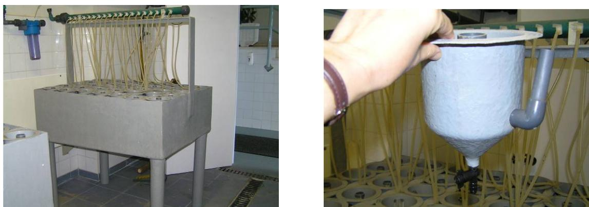
**Figura 3.8.** Sistema de incubadores de 1 L con renovación continua de agua de mar filtrada por 1  $\mu$ m.
