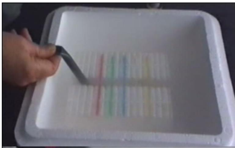
**Figura 3.6.** Caja y flotador de poliestireno expandido utilizado para la crioconservación de esperma de lenguado senegalés.
