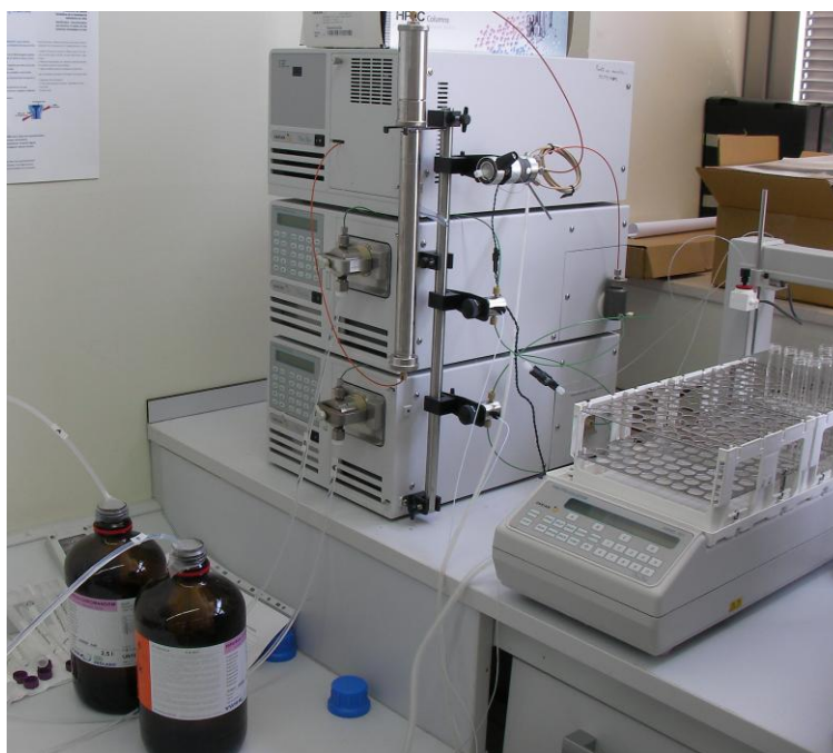
Figura 14. Cromatógrafo HPLC semipreparativo modelo ProStar Variant
