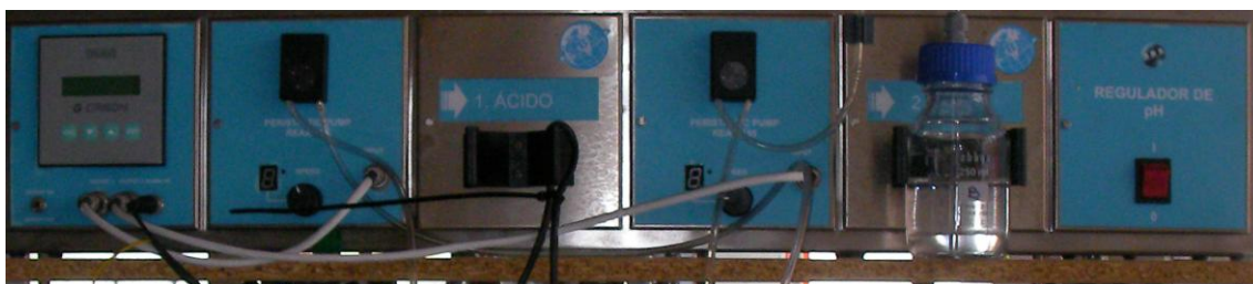
Figura 16. Regulador de pH conectado al biorreactor
