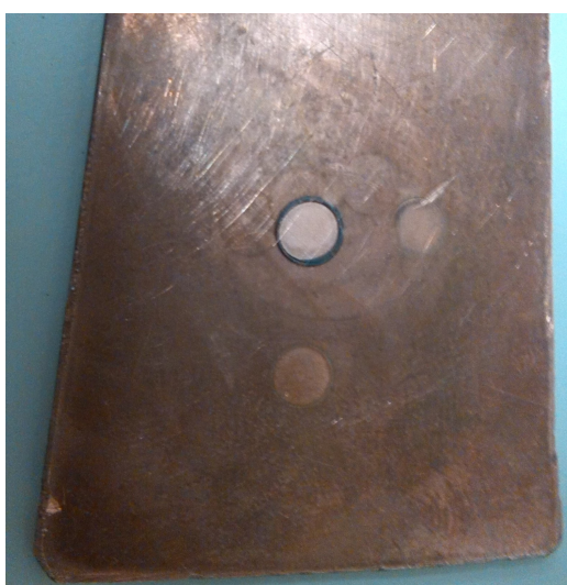
Imagen 38. Cráter en la muestra con cobre
