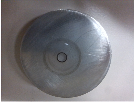
Imagen 37. Cráter en la muestra sin cobre
