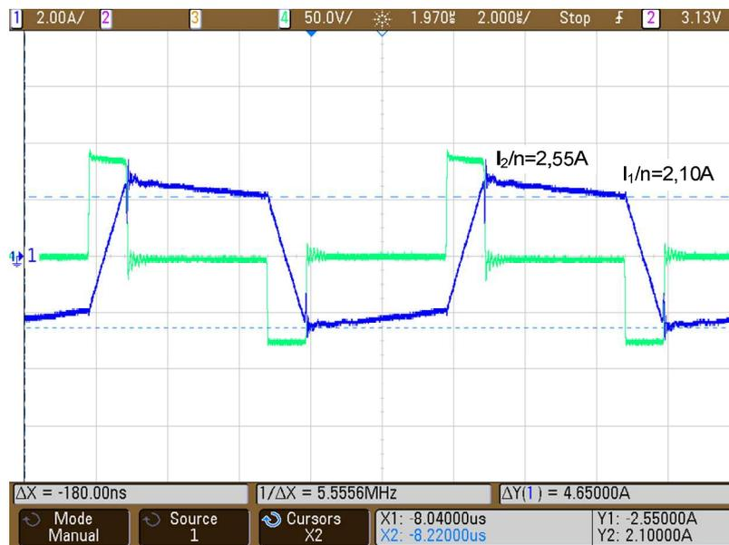
Figura 3.16. Formas de onda de tensión (verde) y corriente (azul) en la inductancia de dispersión del prototipo. La forma de onda de la corriente es medida en el secundario.
