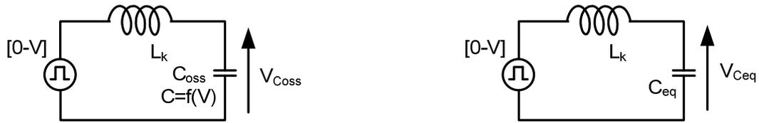
Figura 5.4. Circuito usado para la obtención de un valor equivalente de condensador de salida de los transistores.
