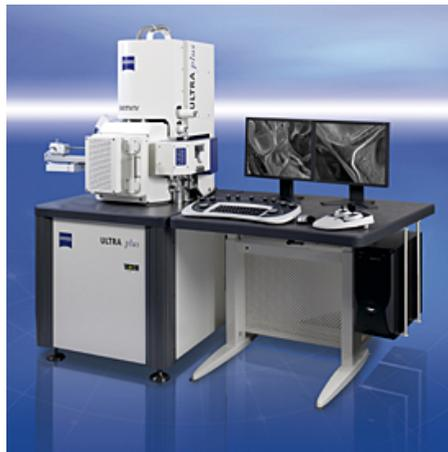
*Figura 2.11. Microscopio electrónico de emisión de campo Zeiss UltraPlus.*
