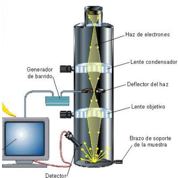
Figura 2.9. Microscopio electrónico de barrido (SEM).
