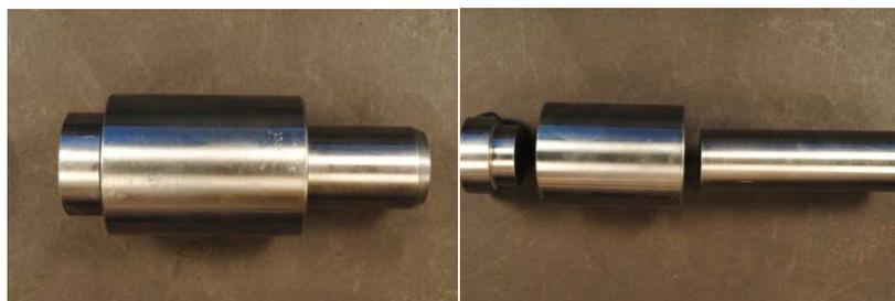
Figura 14: Molde cilíndrico de acero empleado en la compactación de las mezclas
