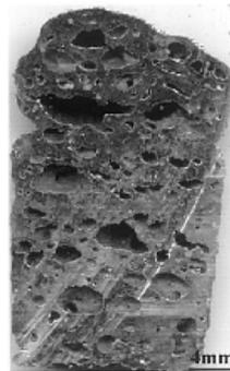
Figura 5: Espuma resultante tras mezcal con molino de bolas.
