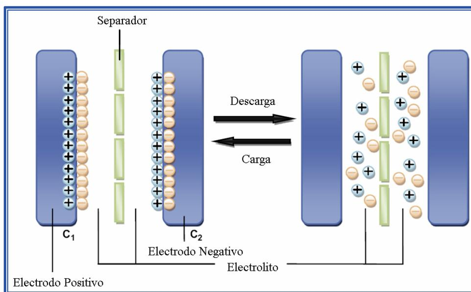
Figura 1.3. Esquema básico de un condensador electroquímico de doble capa (EDLC) durante los estados de carga y descarga. Adaptado de la referencia [LI, 2013].
