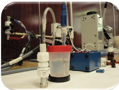
Figura 3.4. Celda electroquímica de tres electrodos.
