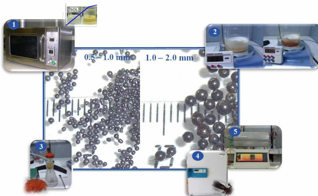
Figura 4.4. Etapas involucradas en la preparación de miliesferas de xerogel de carbono.
