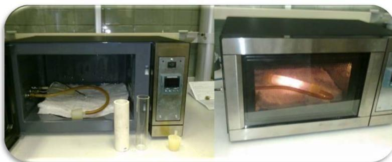
*Figura 4.3. Horno microondas utilizado en los procesos de activación.*
