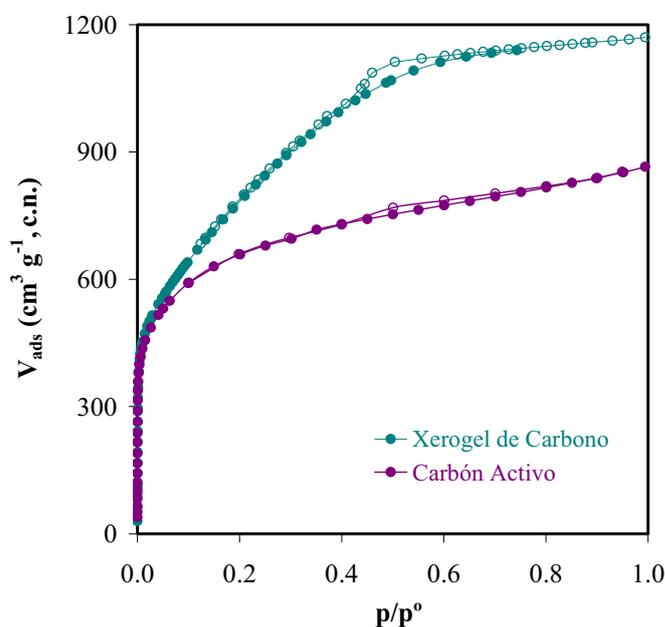
Figura 5.5. Isotermas de adsorción-desorción de  $N_2$  de los materiales de electrodo utilizados en la *Publicación IX*.
