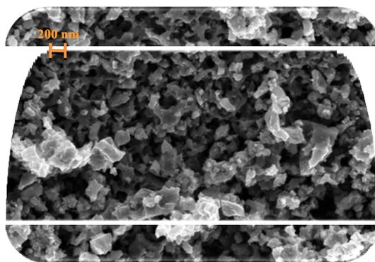
Figura 3.2. Fotografía SEM de un xerogel de carbono sintetizado en el laboratorio.
