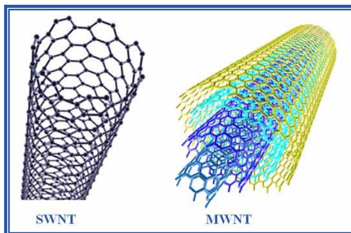
Figura 5.1. Tipos de nanotubos de carbono según el número de capas.
