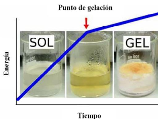
Figura 4.2. Fases involucradas en la síntesis de un xerogel orgánico.
