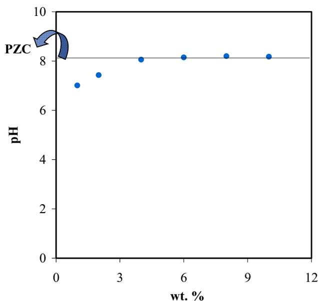
Figura 3.1. Determinación del punto de carga cero.
