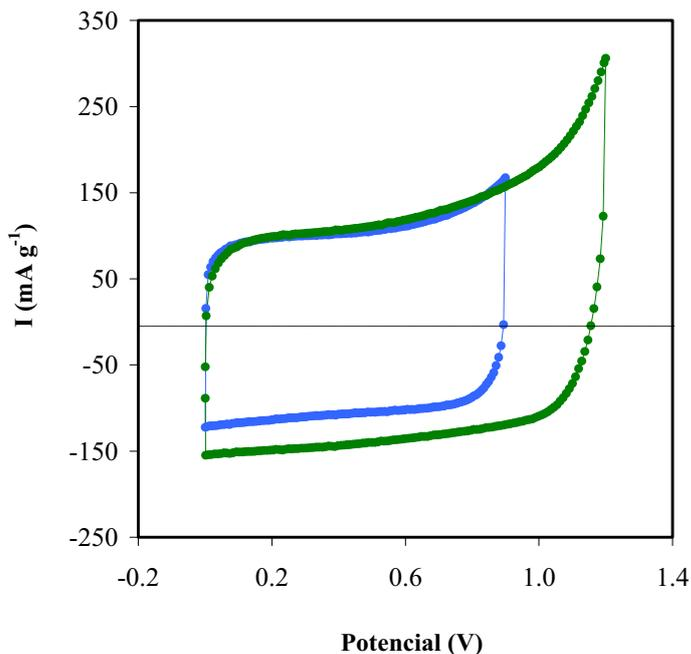
Figura 3.6. Voltamogramas obtenidos con distintas ventanas de potencial ( $s = 2 \text{ mV s}^{-1}$ ).
