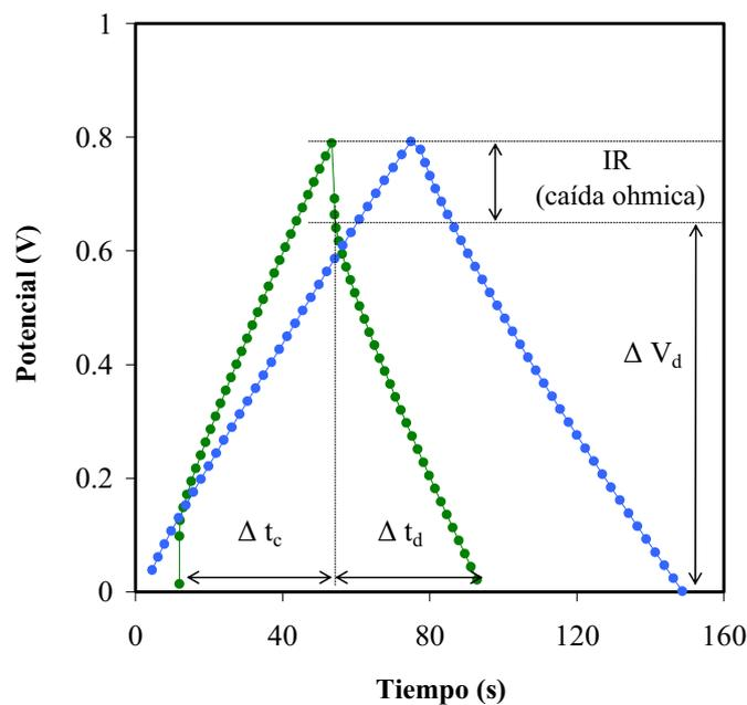
Figura 3.5. Ejemplo de ciclos de carga-descarga ( $I = 500 \text{ mA g}^{-1}$ ).
