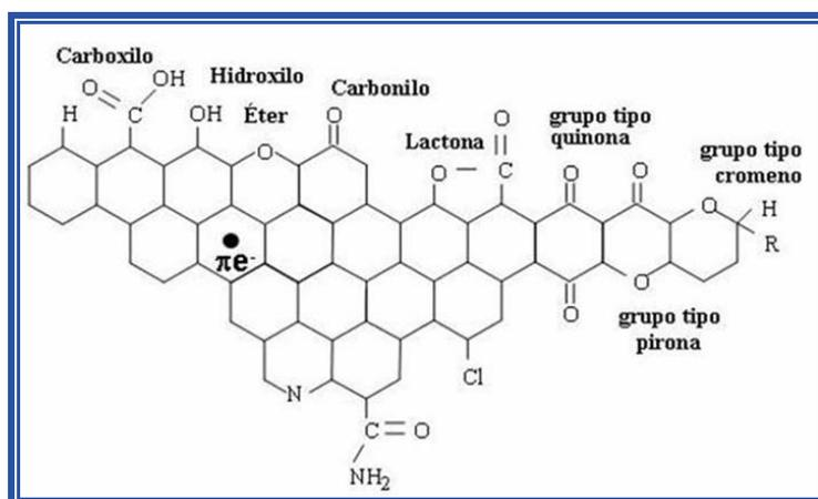
Figura 5.3. Principales grupos funcionales que se pueden encontrar en la superficie de un material carbonoso.
