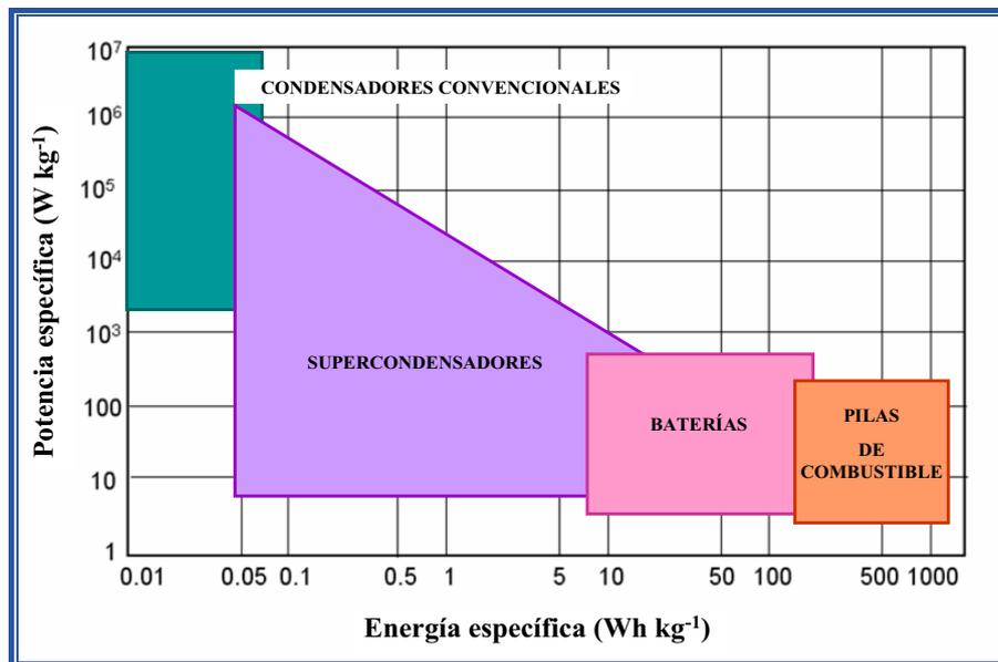
Figura 1.2. Diagrama de Ragone para distintos dispositivos de generación y almacenamiento de energía. Adaptado de la referencia [WINTER, 2004].
