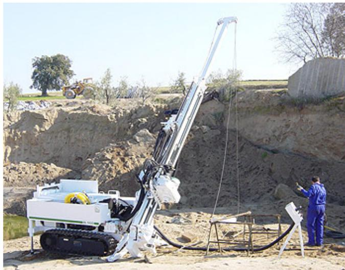
Figura 39. Ejemplo de máquina de perforación sobre orugas.
