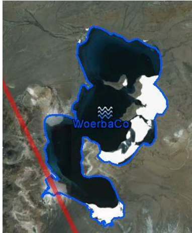
Detalle de traza demasiado próxima a la orilla
