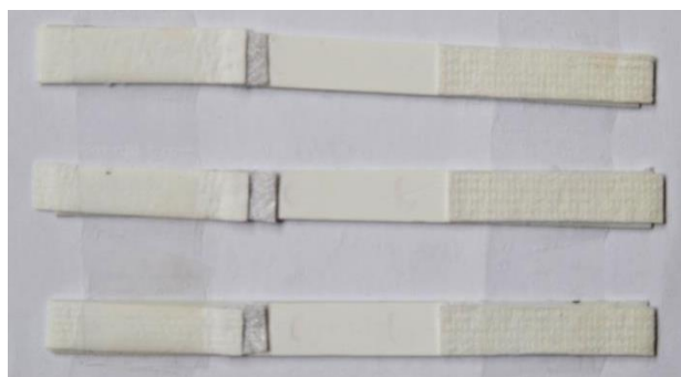
Figura 21 Revelado del ensayo utilizando una concentración de muestra de 4ng/ml, membranas de 15, 10 y 8 \mu m (de arriba abajo)
