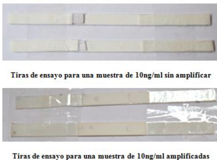
Figura 25 Amplificación por inmersión en una disolución Plata. La concentración de PSA era de 10 ng/mL. Las membranas eran de 10 y 8 \mu m
