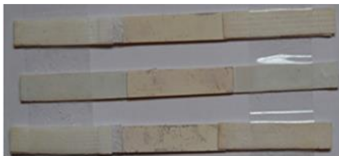
Figura 27 Tiras con anticuerpo conjugado inmovilizado y muestra de 60ng/ml, amplificadas con un formato sándwich de plata y disolución reductora. Tamaño de poro 15,10 y 8µm.
