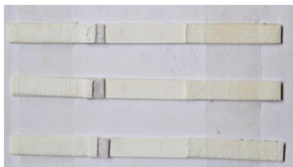
Figura 23 Revelado del ensayo utilizando una concentración de muestra de 60ng/ml, membranas de 15,10 y 8 \mu m (de arriba a abajo)
