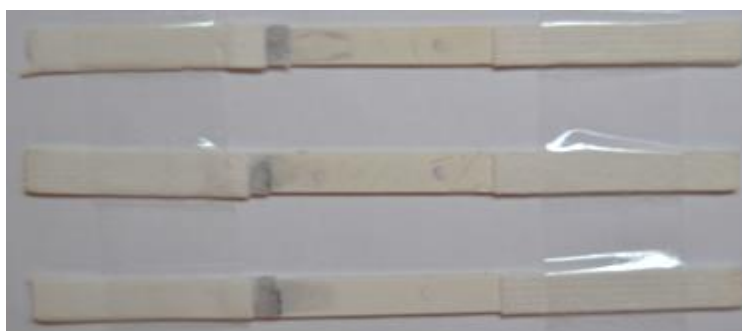
Figura 29 Adición del Nitrato de Plata sobre la almohadilla conjugada
