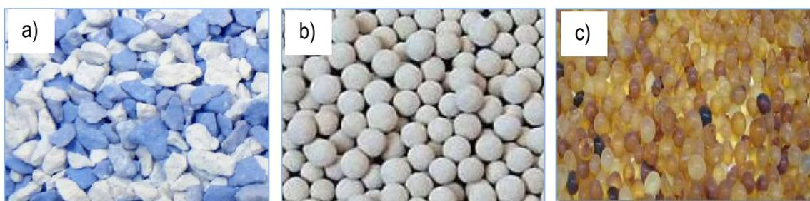
**Figura 6.** Partículas deshidratantes que se pueden utilizar en el HRIMS: a) Drierita, b) *Molecular sieve* y c) Gel de sílice
