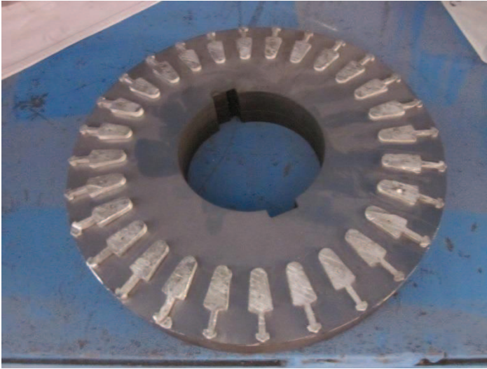
Fotografía6.- Rotor interno con inyección de aluminio (talleres Zitrón)
