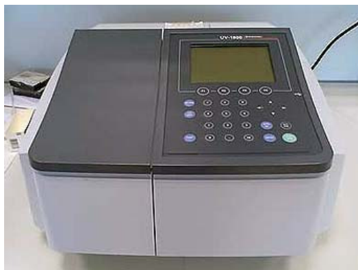
Figura 3.7. Espectrómetro UV-1800 Shimadzu
