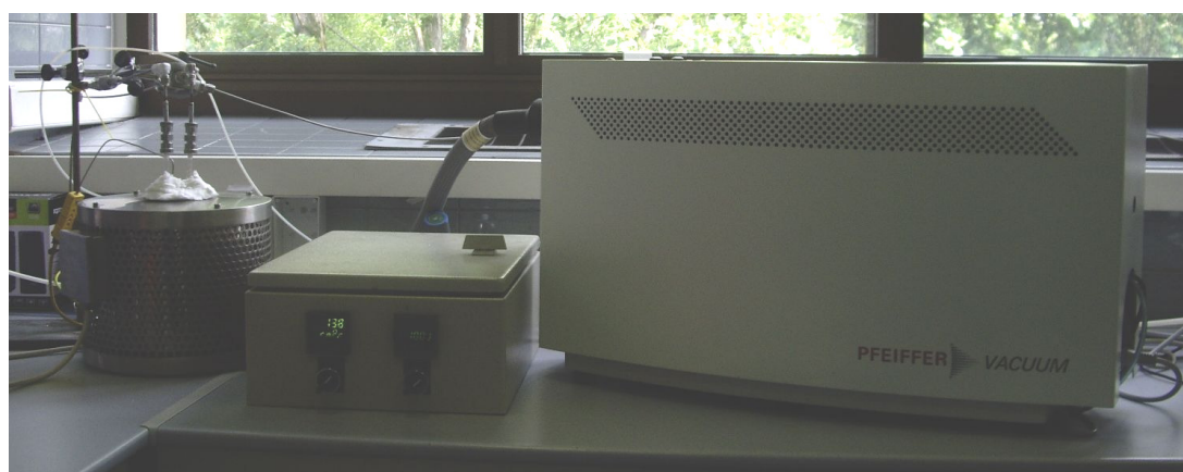
Figura 3.1. Equipo de análisis de desorción térmica programada
