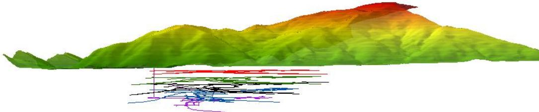
**Figura 41:** Visualización 3D con ArcScene del plano de labores mineras de Valle y el modelo digital de elevaciones de la zona.
