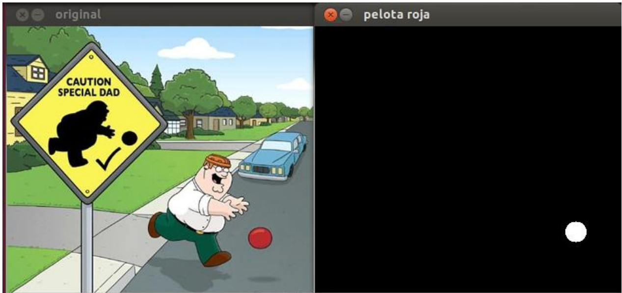
Figura 5.10 – Identificación de objeto de color rojo con OpenCV
