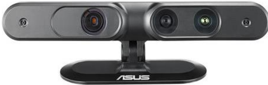
Figura 2.1 - Sensor imagen 3D Asus Xtion
