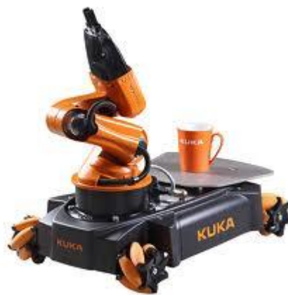
Figura 3.6 - Manipulador móvil Kuka YouBot
