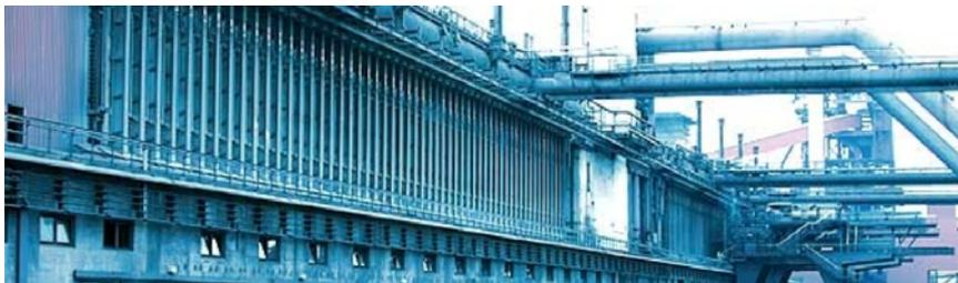
**Figura 3.** Detalle de una batería de hornos de coque con los tubos de recogida de los gases de coquización.
