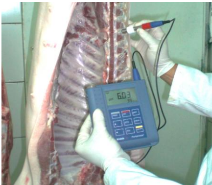
Figura 12: Medida del pH con un pH-metro portátil con electrodo de penetración.
