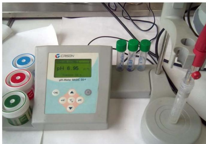
Figura 22. pH-metro utilizado en los análisis del pH.
