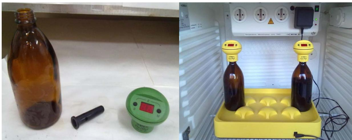
Figura 19. Equipo OxiTop® para la determinación de la DBO<sub>5</sub>: Botella con cabezal medidor y trampa de CO<sub>2</sub> (izquierda); soporte con agitación (derecha) colocado en el interior del frigo-termostato.
