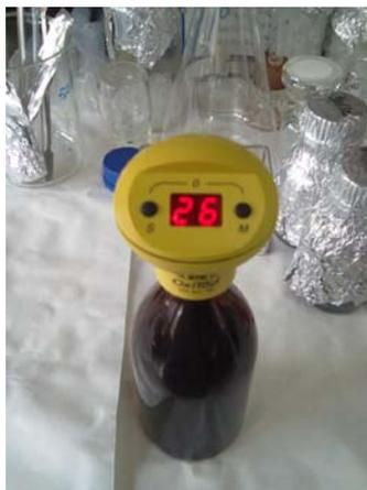
Figura 20. Display incorporado en el cabezal medidor que muestra los valores registrados cada 24 horas.
