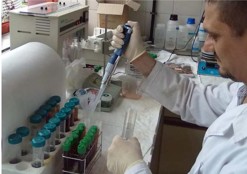
Figura 16. Extracción y trasvasado del sobrenadante formado tras la centrifugación de las muestras.
