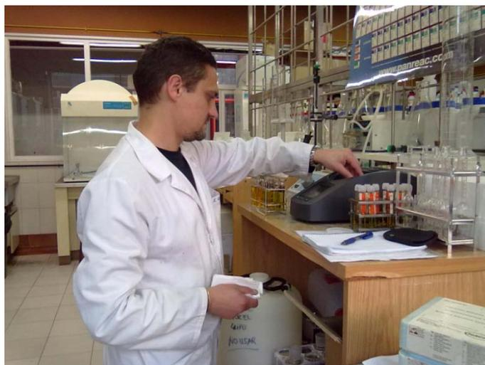
Figura 18. Lectura de la absorbancia de las muestras en el espectrofotómetro.
