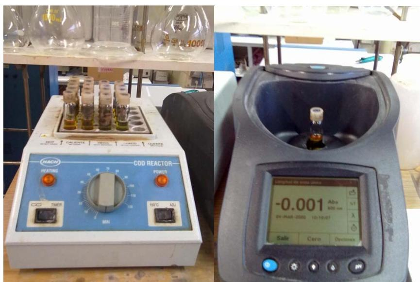
Figura 17. Equipo para la determinación de la DQO: termo-reactor (izquierda); espectrofotómetro (derecha).
