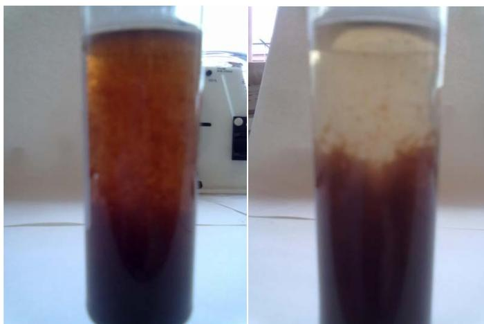
Figura 13. Formación de flóculos: inmediatamente después de la aplicación del coagulante (izquierda) y 1 minuto después aproximadamente (derecha).
