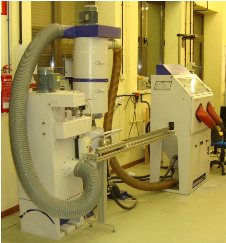
Fotografía 10. Equipo de tratamiento de shot peening
