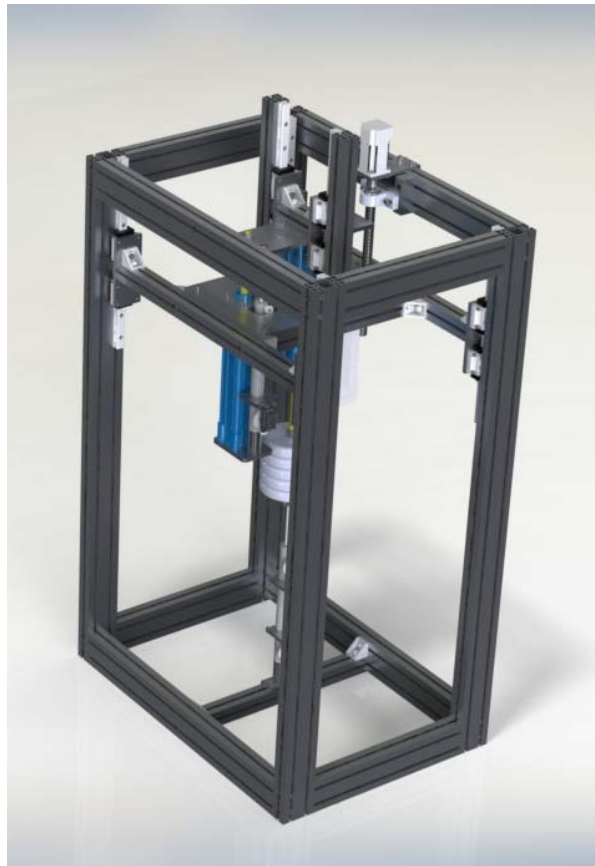
Figura 35. Vista tridimensional del tercer diseño mecánico propuesto. Mejoras en el ensamblaje y alineación de guías.
