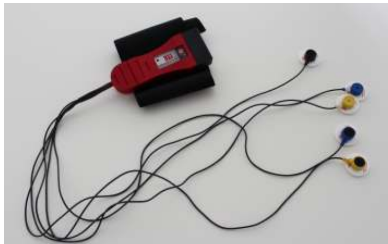
Figura 4.- Muestra el modelo de Bioamplificador QPET 2 Brainquiry con los electrodos de superficie correspondientes
