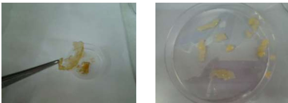
Fig. 12. Comparación visual de las dos formas distintas de almacenamiento de los geles del ensayo A. En la izquierda, después de estar 24 horas a 4\pm 1^{\circ}\text{C} y en la derecha después de introducirlos en agua destilada
