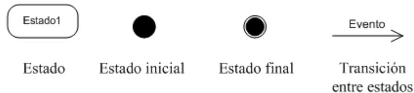
Figura 16. Elementos de un diagrama de estados
