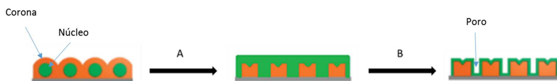
Figura 6: Esquema de la obtención de poros por reconstrucción superficial, a partir de una morfología micelar
