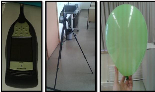
Figura 2. A la derecha del todo el tipo de globos utilizado, en medio el sonómetro fijado por su trípode y a la izquierda el sonómetro utilizado para hacer las mediciones.
