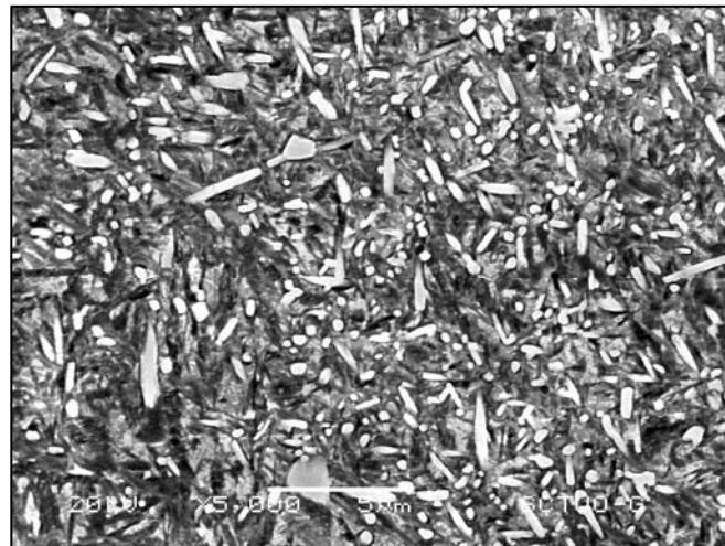
Figura 6.28 Fundición blanca alta en cromo con tratamiento de temple a 1000 °C (5.000x) Región dendrítica con abundante precipitación de carburos
