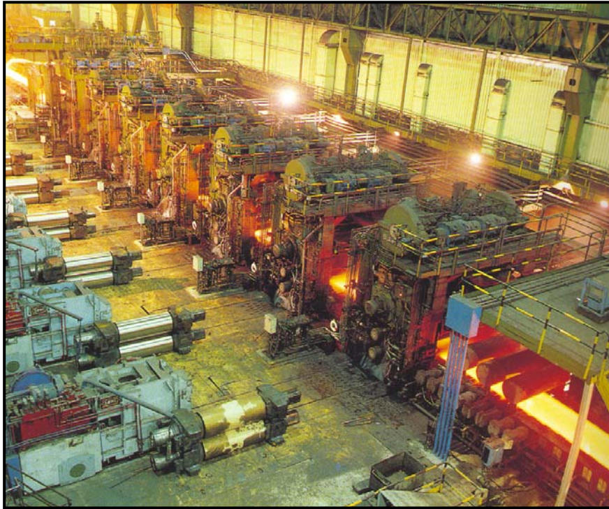
Figura 2.3 Tren de laminación de bandas de la empresa Aceralia
