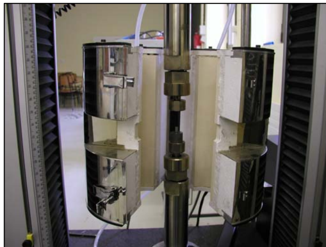
Figura 4.21 Horno Instron en máquina de ensayos mecánicos Instron
