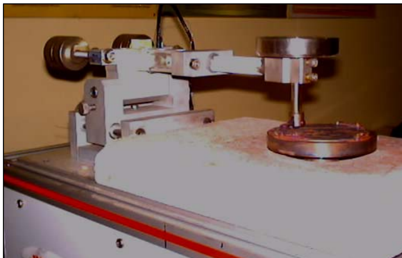
Figura 4.27 Tribómetro utilizado en los ensayos de desgaste en caliente
