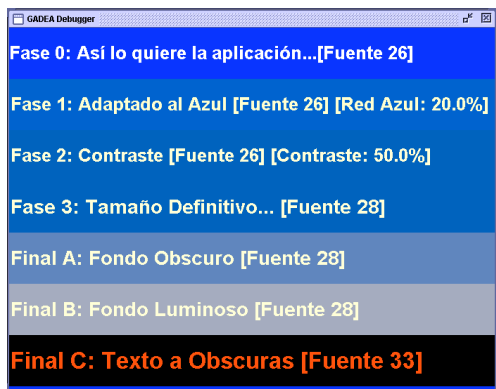
Figura 77. Adaptación visual del ejemplo de la Figura 76 cuando el usuario es más joven y por lo tanto la cantidad de azul a retirar es menor (20%). Nótese como tras el proceso de eliminación de parte del azul en la primera fase de adaptación, los resultados no son tan drásticos como en la Figura 76, ya que el color de fondo sigue siendo azul (en un tono más pálido) y no verde (consultar versión en color en el capítulo 24: Imágenes en Color , p. 445).
