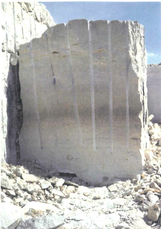
Fig. 2.3.- Aspecto en cantera de la Caliza del Páramo. La variedad P-1 corresponde a la banda intermedia más oscura, y la P-2 a la zona más blanquecina inmediatamente inferior.
