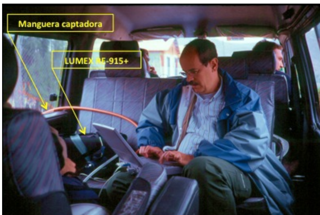
Figura 49. Procedimiento estándar del grupo de trabajo de Almadén (UCLM) para la medición de Hg_{gas} desde un vehículo, en este caso, en el Distrito Minero de Andacollo (Chile) (Higueras et al., 2005). Un procedimiento análogo se utilizó en las carreteras comarcales y caminos transitables en automóvil de Almadén.
