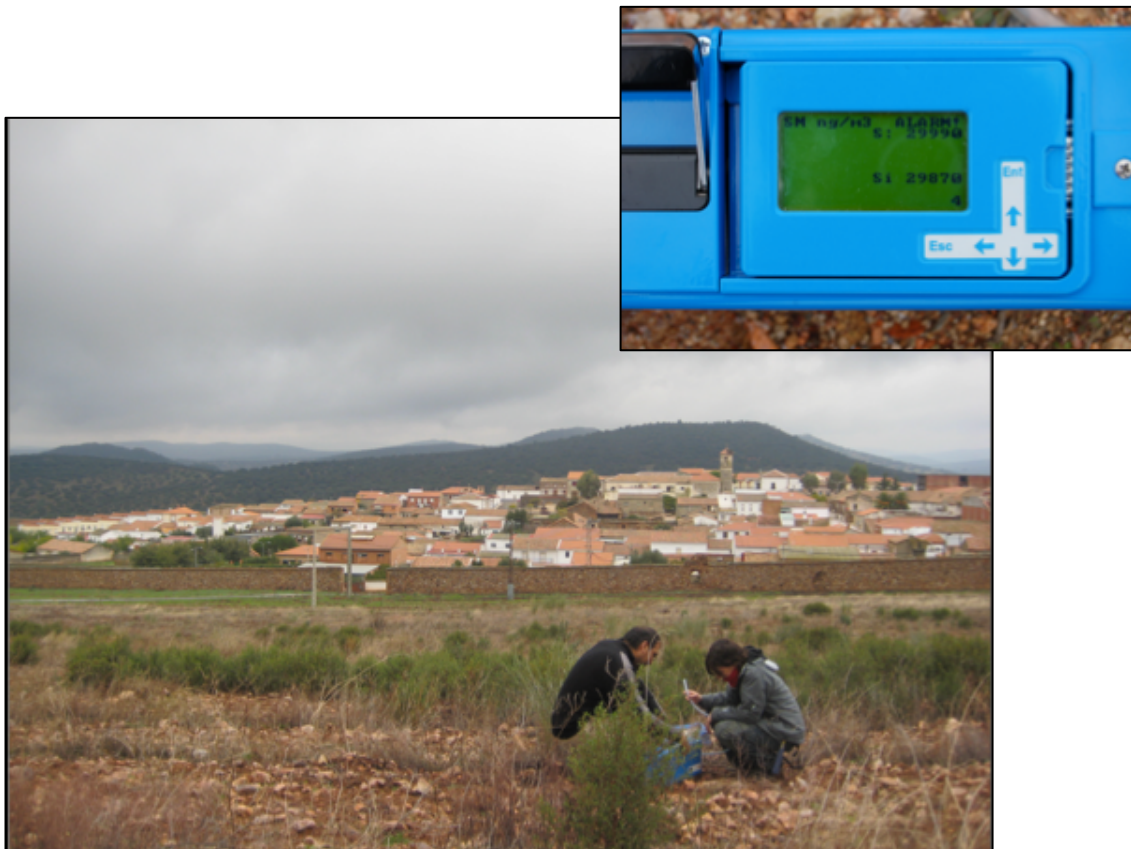
Figura 44. Toma de muestras de aire con el analizador LUMEX RA-915+. Al fondo el pueblo de Almadenejos; Recuadro: lectura (ng Hg m -3 ) del LUMEX RA-915+ en el Cerco de Almadenejos.
