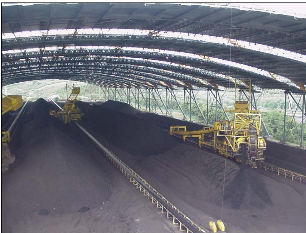
Figura 268: Apilamientos cerrados en parque de central térmica
