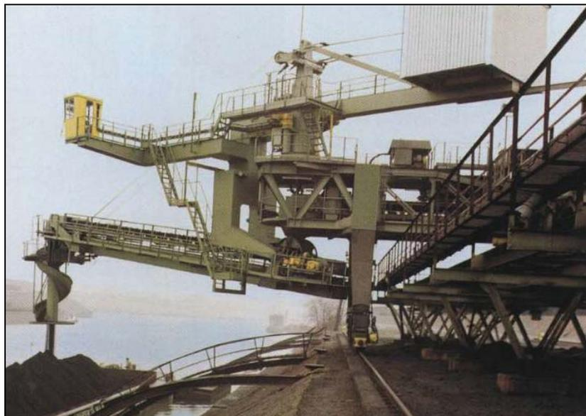
Figura 8: Apilamiento-carga mediante auger
