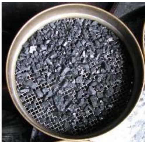
Figura 12: Criba de 4 mm
