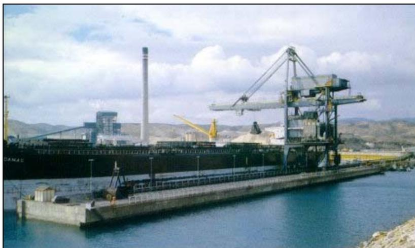
Figura 25: Descarga discontinua mediante cuchara en puerto interior de Central Térmica
