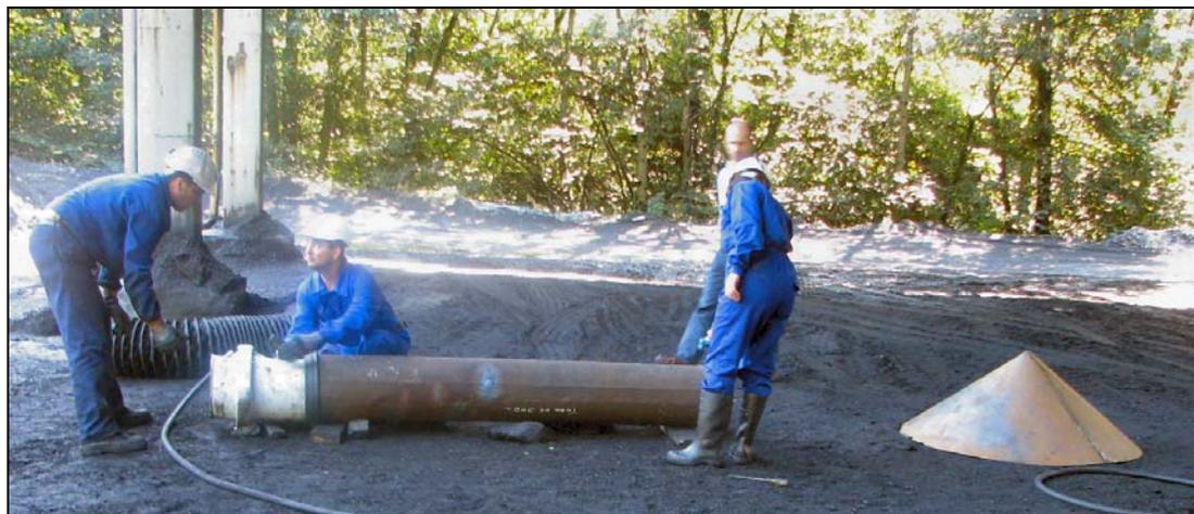
Figura 149: Instalación del ventilador, manga y cono utilizado en los ensayos
