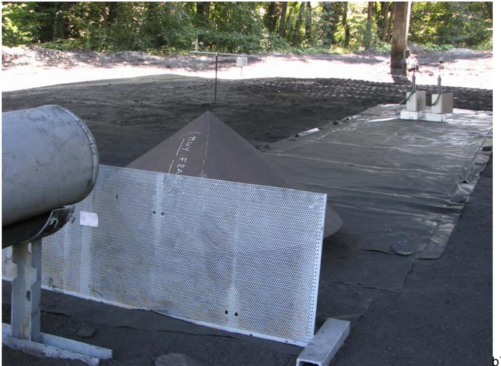
Figura 64: Ensayo barrera porosa y polvo. Croquis a) y ensayo b)
