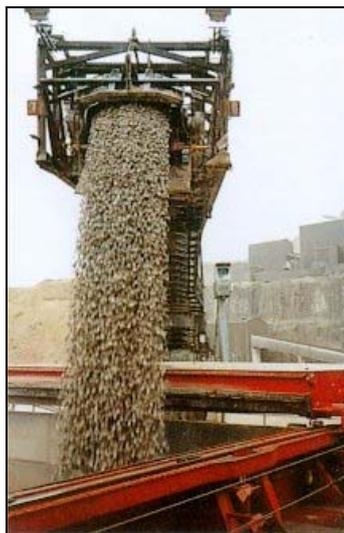
Figura 4: Carga con cinta de roca industrial
