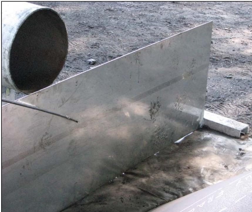
Figura 233: Medida de velocidad por detrás de la barrera
