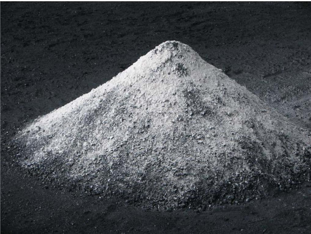
Figura 21: Apilamiento cónico de caliza
