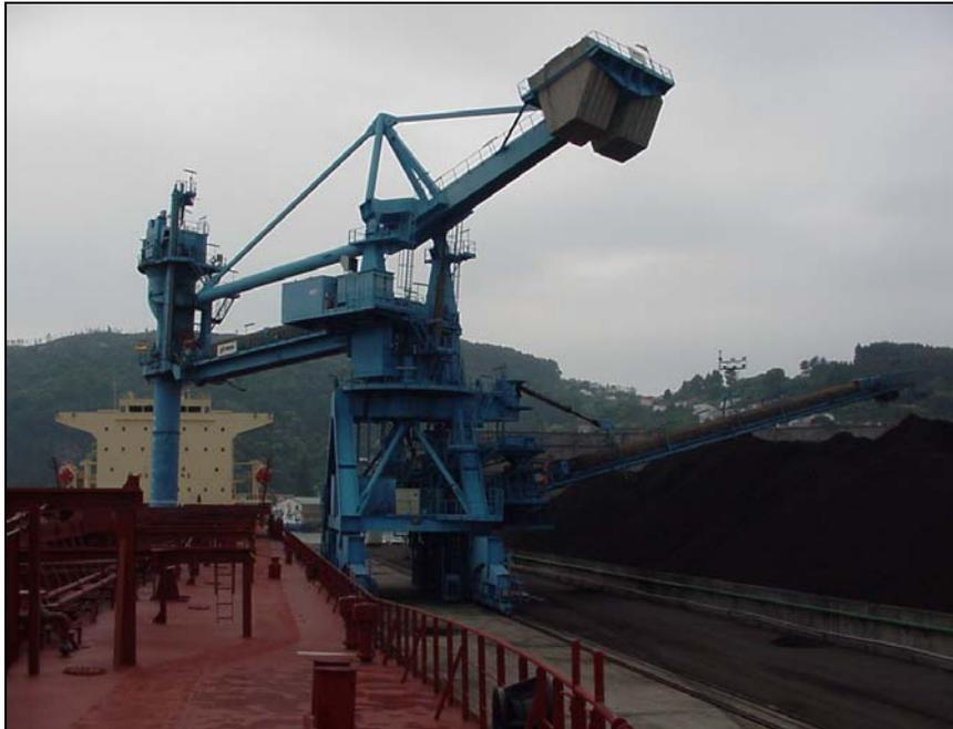
Figura 107: Descargadora continua de barcos
