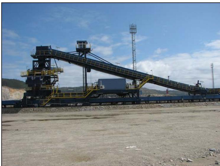
Figura 14: Apiladora de brazo en una terminal portuaria del Norte de España
