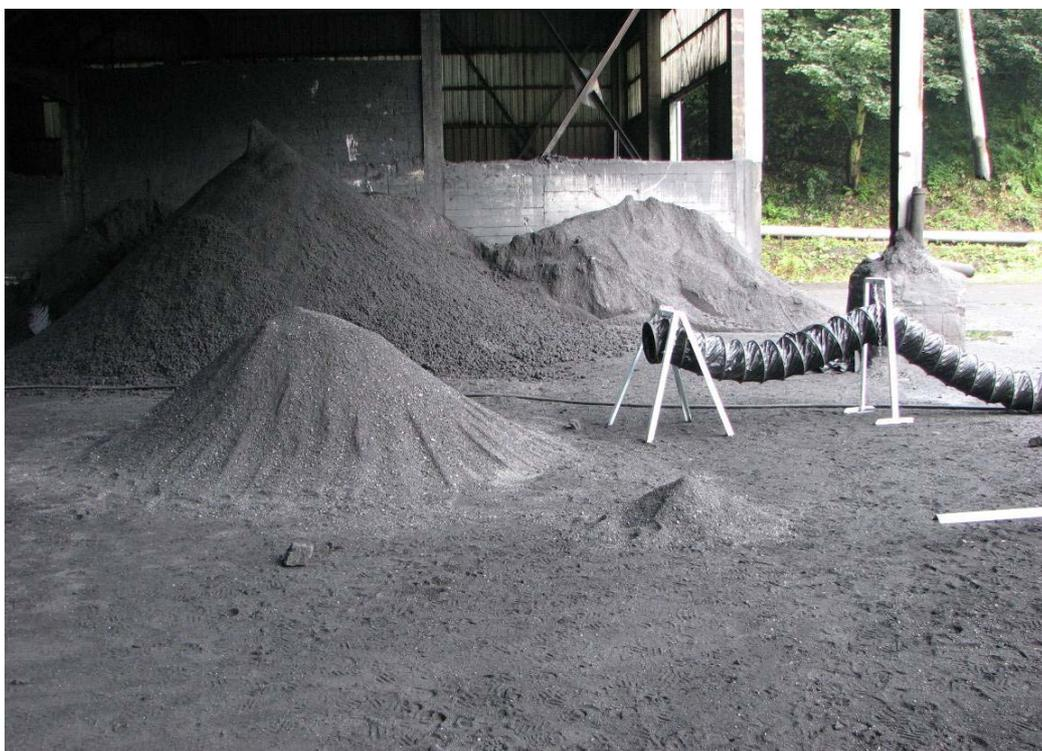
Figura 19: Ubicación de tubería soplante y apilamientos cónicos
