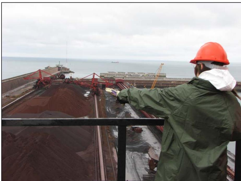
Figura 2: Apilamiento en parque a intemperie mediante apiladora-recogedora
