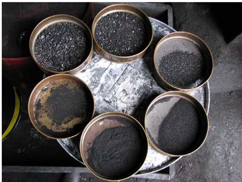
Figura 17: Resultado del tamizado
