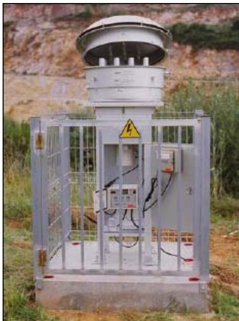
Figura 37: Captador HVS PM10
