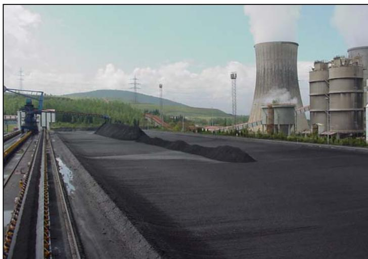
Figura 13: Formación de parva mediante apiladora en Central Térmica
