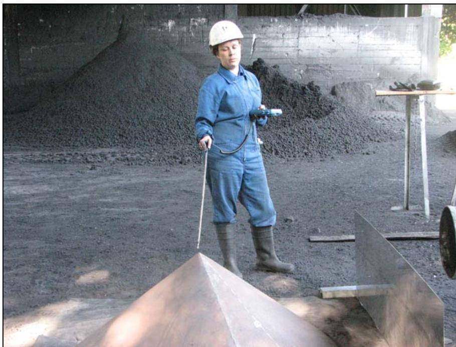
Figura 232: Medidas con anemómetro de hilo caliente
