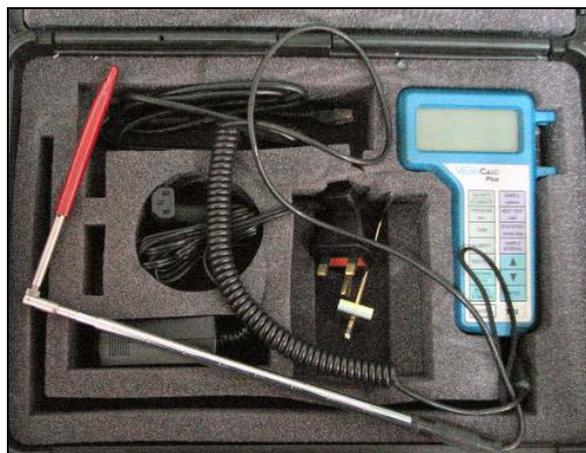
Figura 151: Anemómetro de hilo caliente
