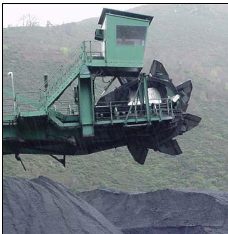
Figura 12: Apiladora-recogedora de rodete en Central Térmica
