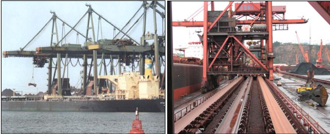
Figura 6: Carga y descarga mediante cuchara
