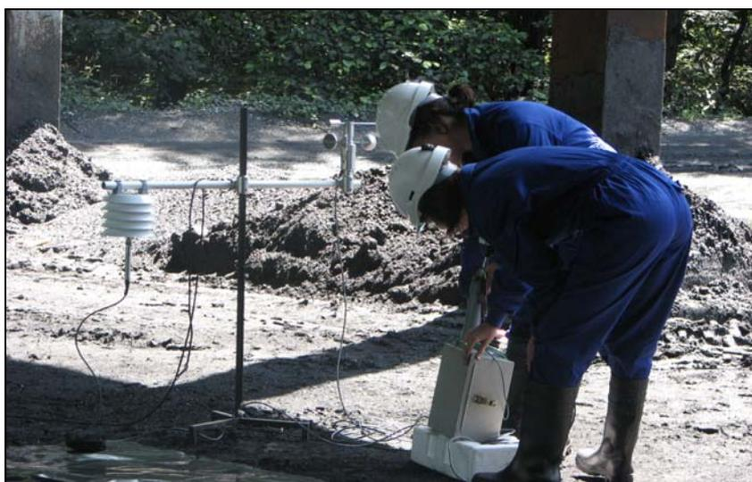
Figura 153: Instalación de estación meteorológica y captadores de polvo
