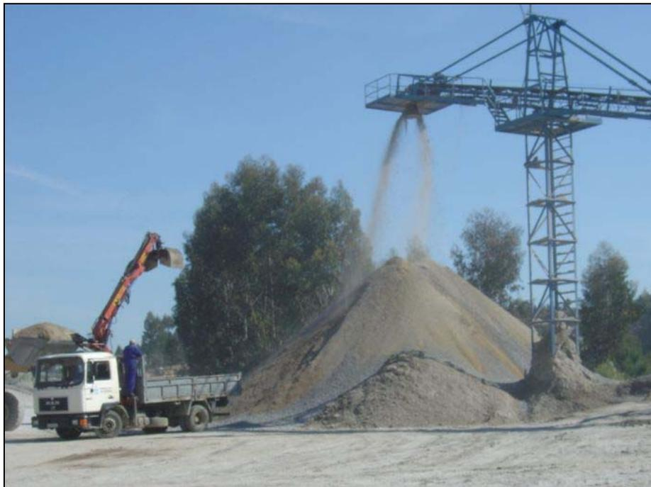
Figura 144: Apilamiento cónico de áridos
