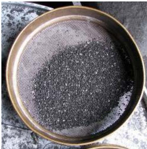
Figura 15: Criba de 1 mm
