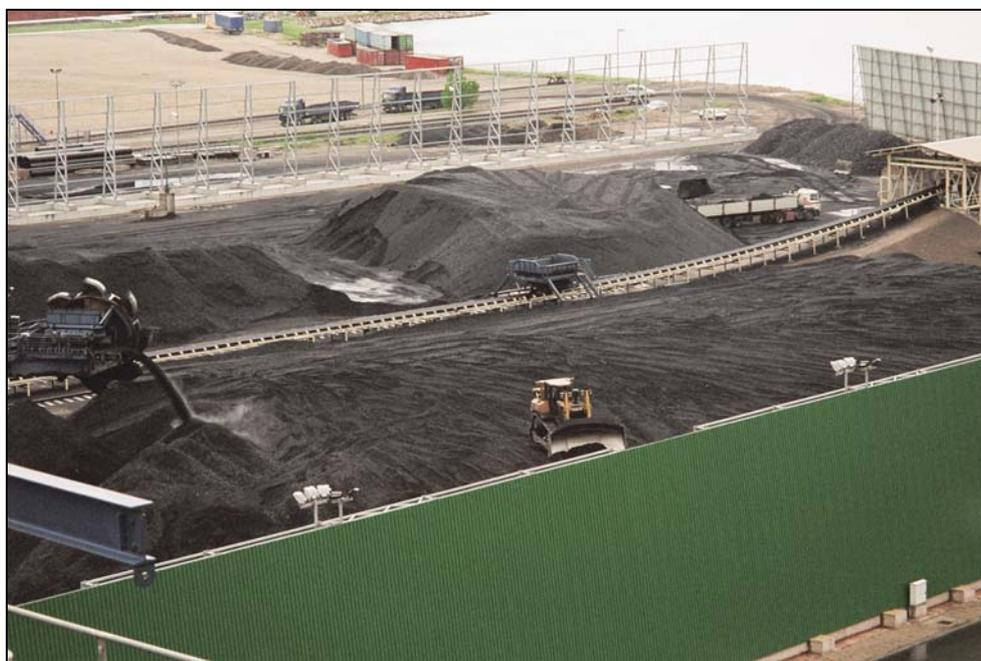
Figura 267: Apilamientos con apiladoras de rodetes y con barreras
