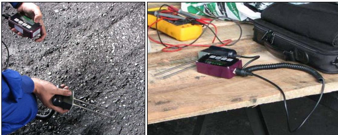
Figura 152: Medidor TDR
