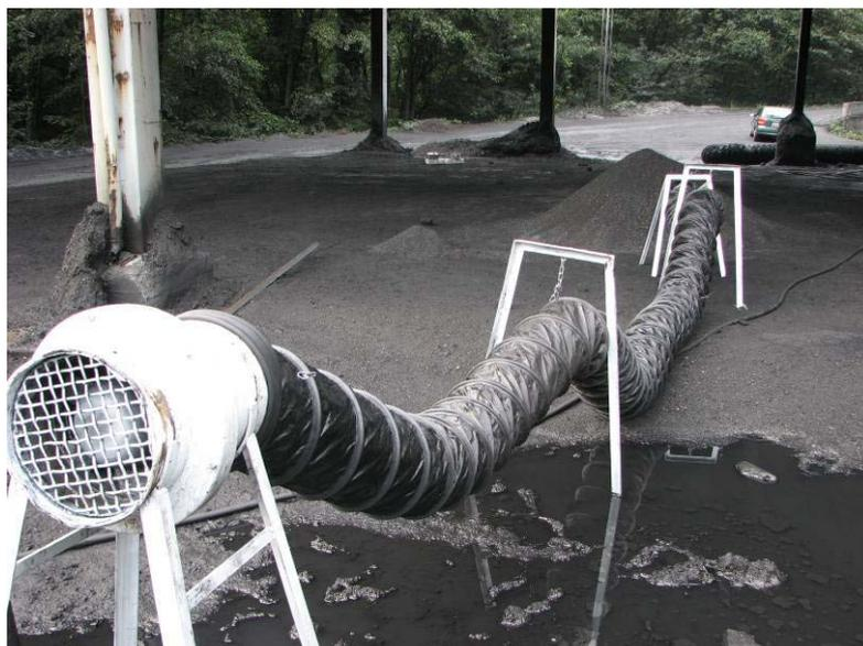
Figura 9: Ventilador, manga enganchada a tres soportes a lo largo de su recorrido
