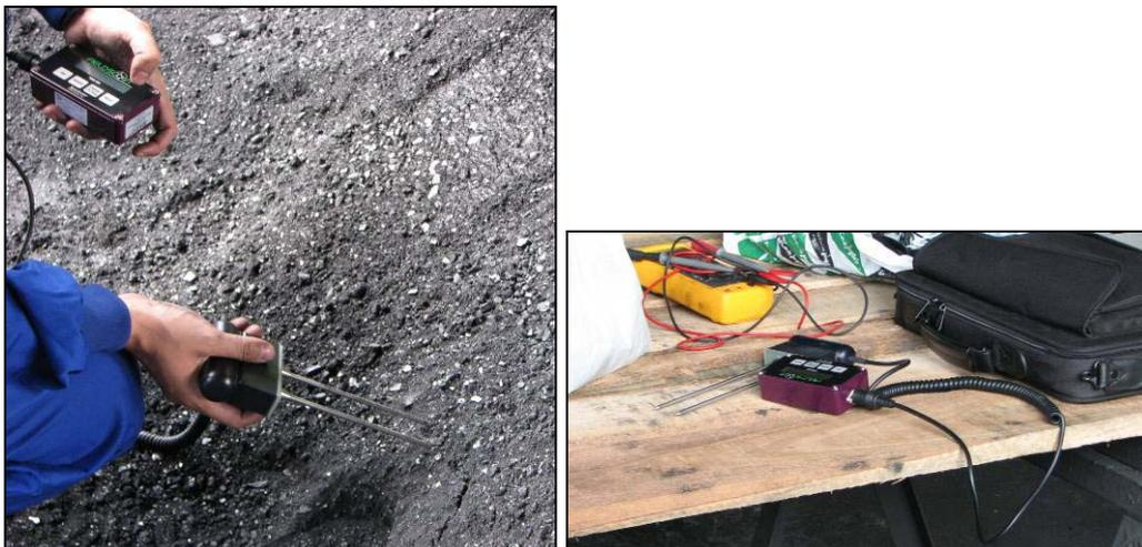
Figura 7: Medidor TDR-100
