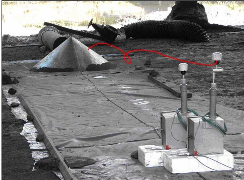
Figura 150: Captadores de polvo y trayectoria simulada de una partícula de polvo
