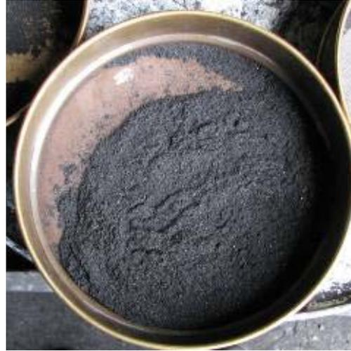
Figura 15: Criba de 0.25 mm
