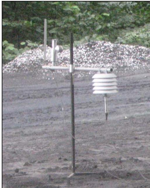
Figura 231: Estación meteorológica
