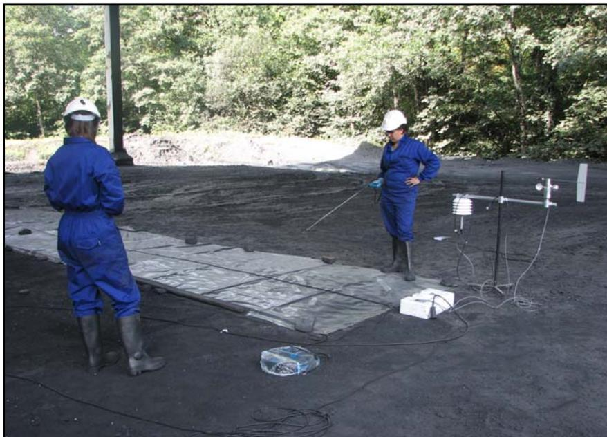
Figura 159: Tomas de medidas de la velocidad de viento
