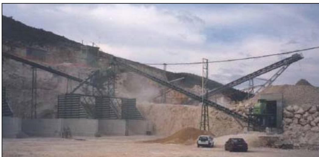
Figura 11: Formación de polvo en trituración de caliza en cantera de fábrica de cemento
