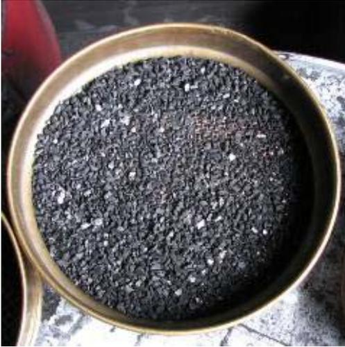
Figura 14: Criba de 2 mm
