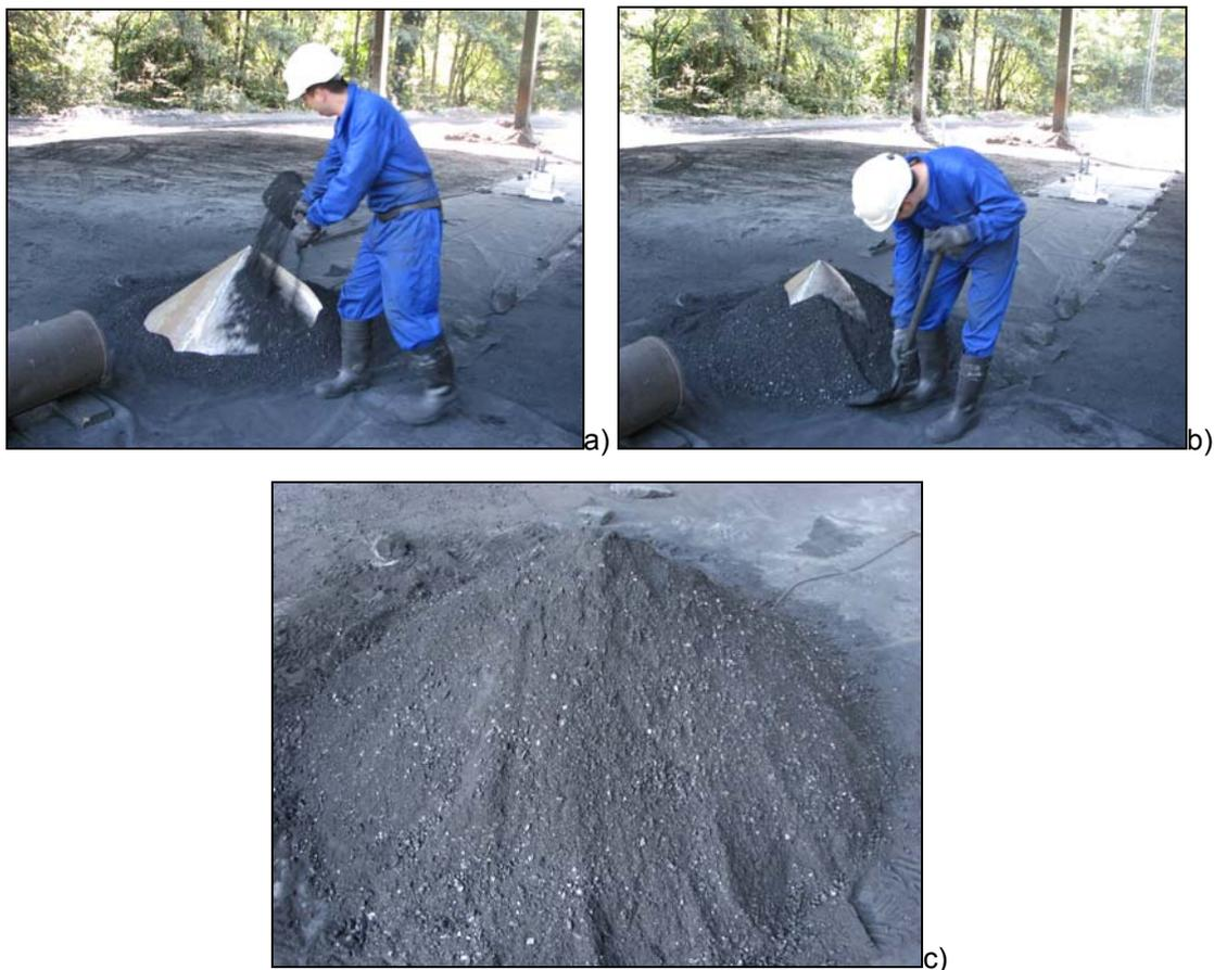
Figura 154: Pila cónica de carbón sobre el cono metálico
