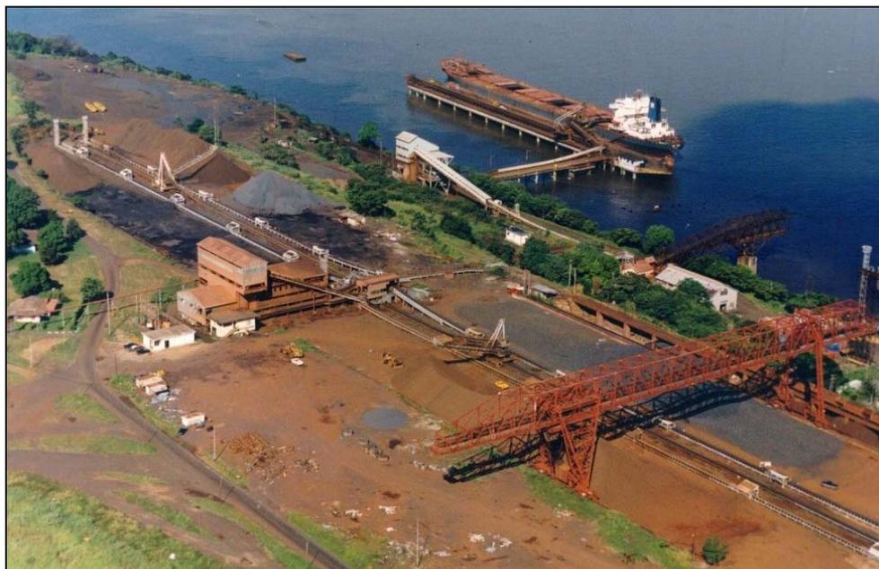
Figura 266: Apilamientos de diversas formas minerales sin barreras
