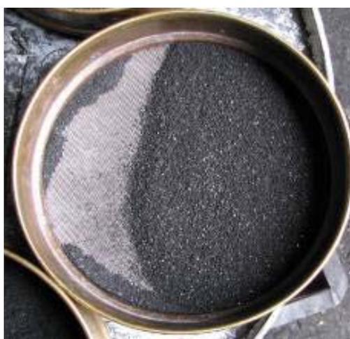
Figura 13: Criba de 0.5 mm
