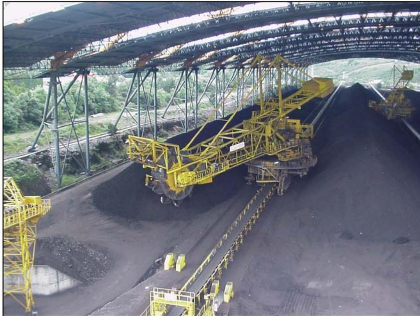
Figura 3: Cinta transportadora en parque cubierto de almacenamiento
