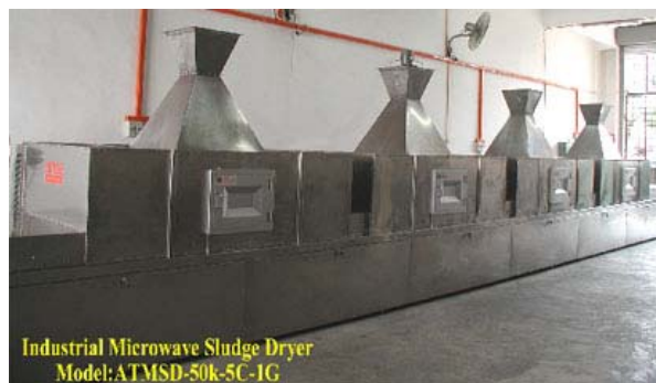
Figura 2.12 Fotografía de un microondas industrial empleado en el secado de lodos.
